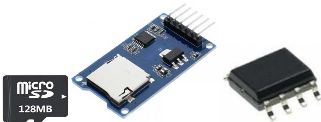
Рисунок 1. Карта Флеш-памяти (слева), модуль MicroSD SPI для Ардуино (в середине) и микросхема памяти W25Q64FVSIQ.
