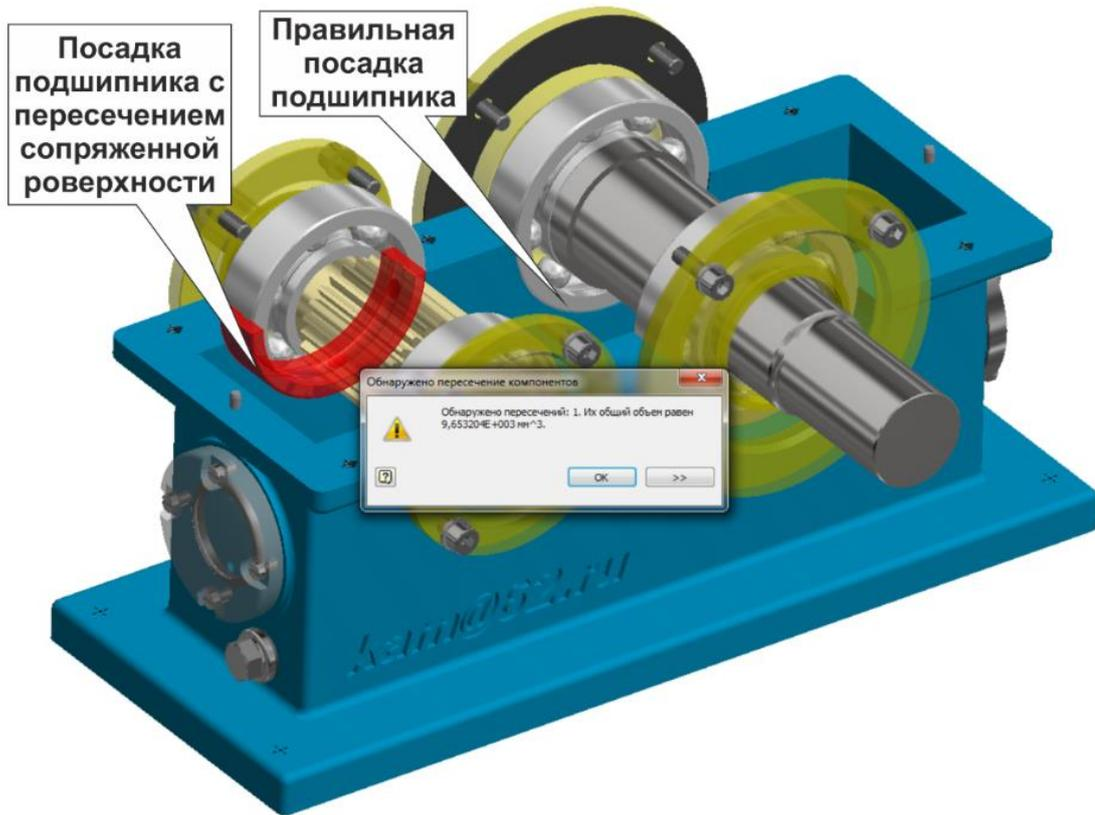
Рисунок 5 – Пример осуществления автоматической проверки пересечений статичных деталей
