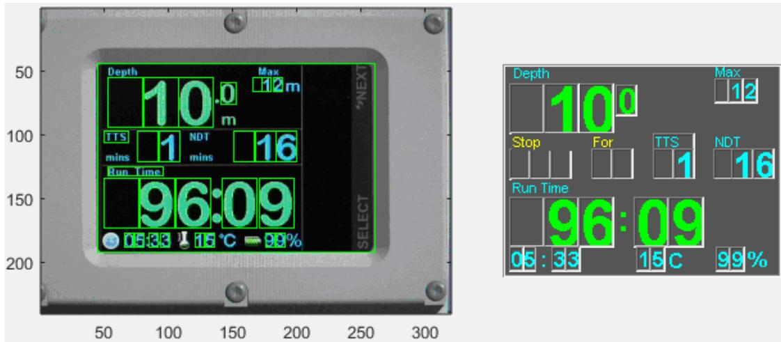
**Рис. 40.** Фрагмент GUI. Видеоизображение объекта частотой 30 Гц выводится слева. Распознанные в выделенных зеленых зонах символы видеопотока отображаются на шаблоне кадра справа. Точность совмещения камеры и объекта определяется положением рамки самой большой прямоугольной зоны левого кадра.
