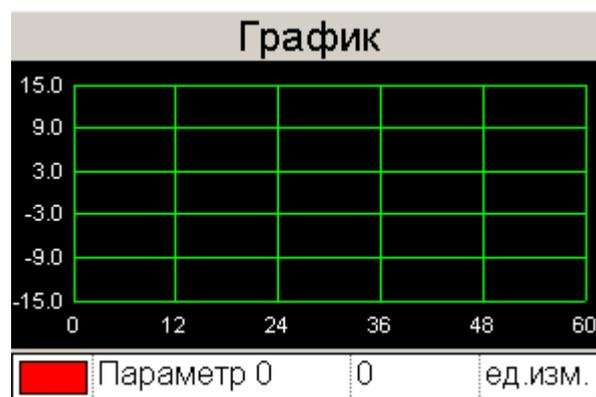
17. Подключите (перетащите) сигнал Sin сервера к графопостроителю MasterSCADA.
