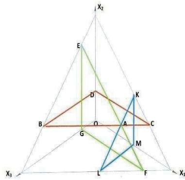
Рис.26 - определение координат точки *A* плоскостным методом
