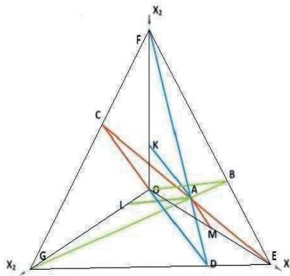
Рис.27 – определение координат точки *A* лучевым методом
