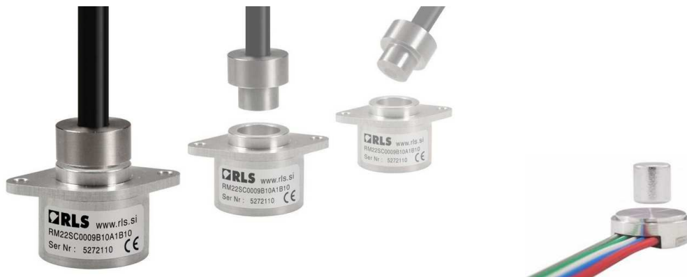
Рис. 7. Преобразователи угловых перемещений серий RM22 (слева, диаметр корпуса 22 мм) и RM08V (справа, диаметр корпуса 8 мм) компании RLS состоит из держателя магнита (верхняя часть), который закрепляется на оси вращения объекта, и неподвижного магнитоэлектрического преобразователя (encoder).
