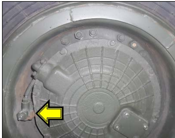
Рисунок 3.ОК-23 – Проверка крепления обода колеса к тормозному барабану, кроме гайки в зоне трубки подвода воздуха к воздушному колёсному крану
