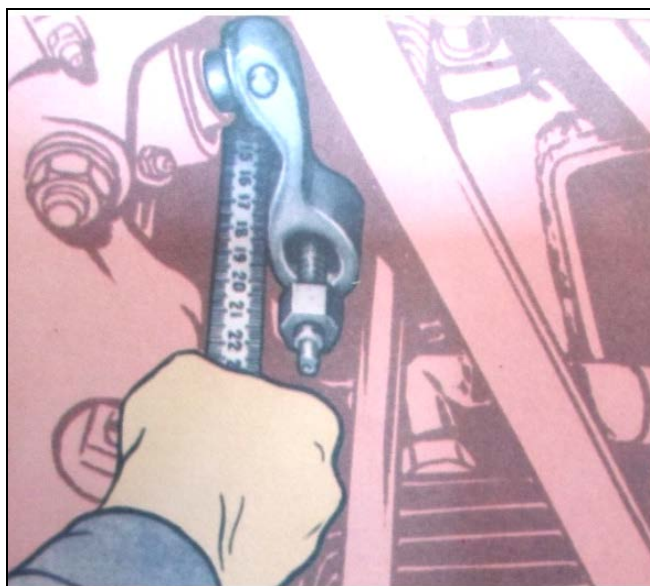
Рисунок 6.ОК-11 – Проверка свободного хода рычага вилки выключения сцепления
