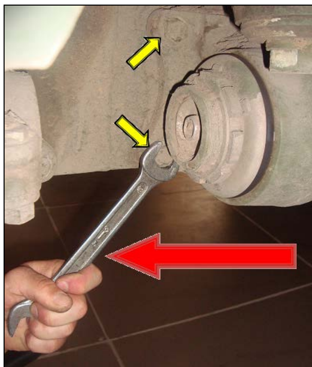
Рисунок 5.ОК-24 – Подтяжка болтов крепления кронштейнов нижних рычагов подвески
