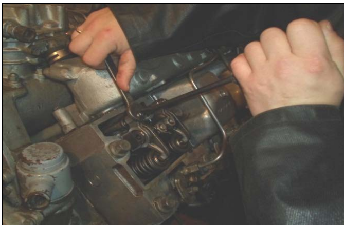
Рисунок 11.ОК-6 – Регулировка зазора
