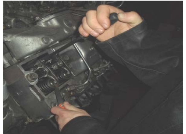
Рисунок 11.ОК-6 – Регулировка зазора
