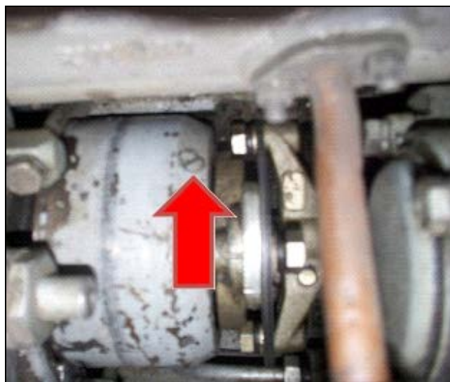
Рисунок 4.ОК-7 – Дозаправка маслом автоматической муфты опережения впрыскивания топлива
