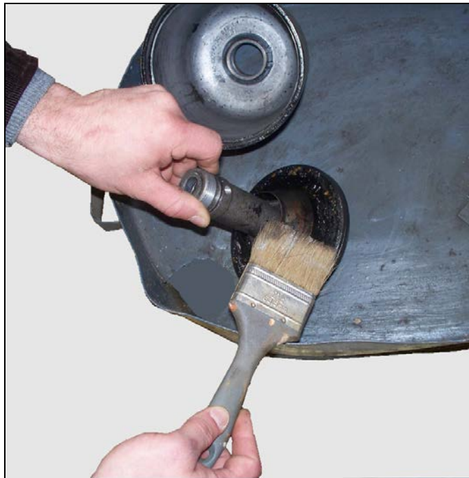
Рисунок 8.ОК-3 – Промывка фильтра центробежной очистки топлива
