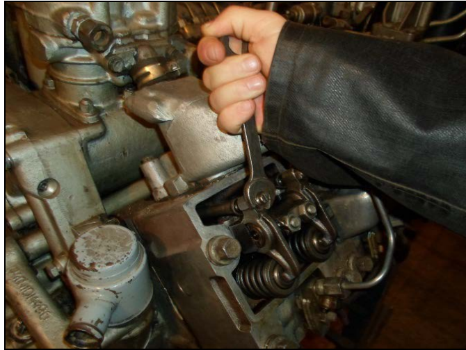
Рисунок 10.ОК-6 – Ослабление гайки регулировочного винта
