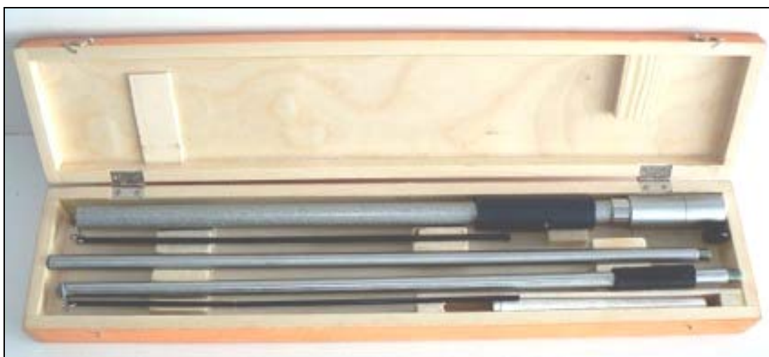
Рисунок 2.ОК-4 – Линейка раздвижная (телескопическая) для проверки сходжения-развала колес легковых и грузовых автомобилей
