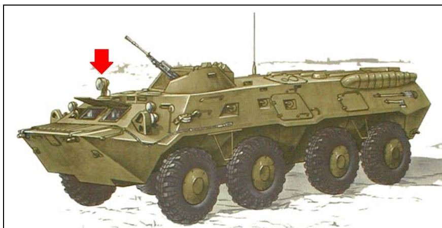
Рисунок 2. ОК-1 – Бронетранспортер БТР-80 (осветитель ОУ-ЗГА2М указан стрелкой)
