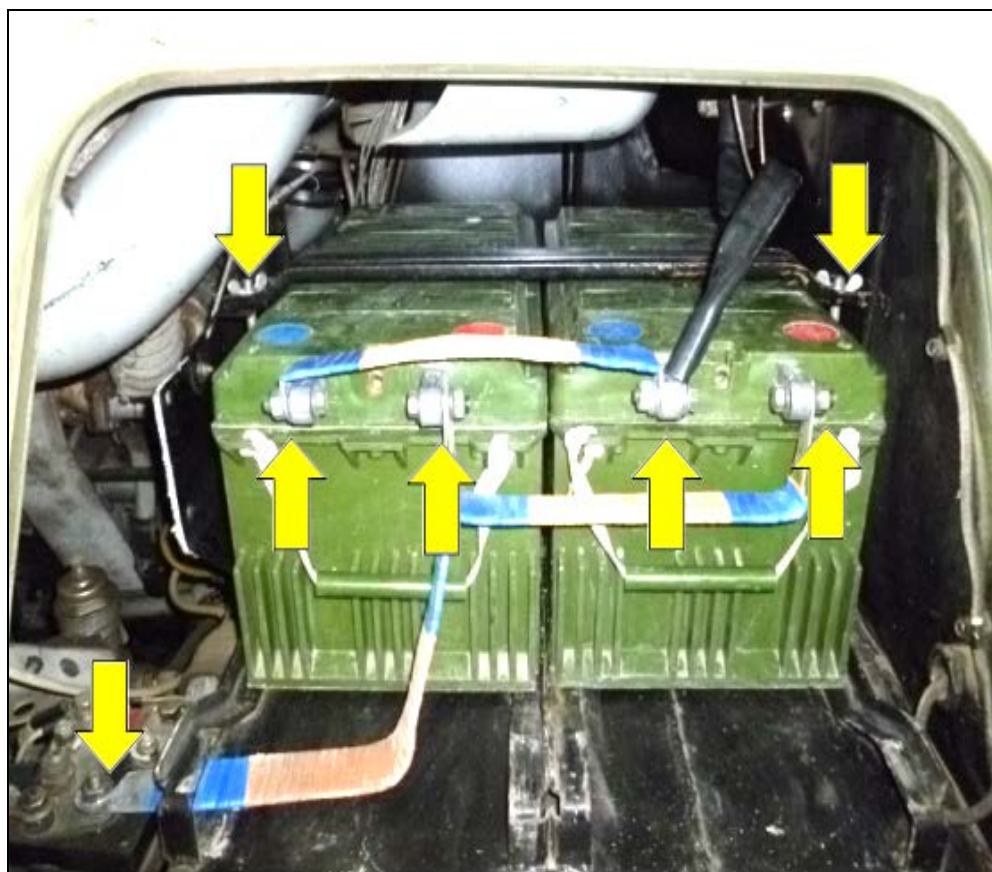
Рисунок 9.ОК-25 – Места проверки надежности крепления батарей в нише аккумуляторных батарей и плотности крепления шин (наконечников проводов) к полюсным выводам батарей
