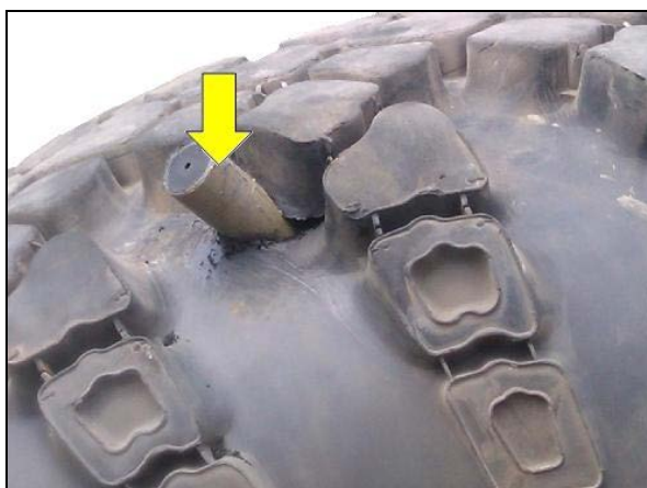
Рисунок 3.ОК-8 – Шина с застрявшим в протекторе посторонним предметом
