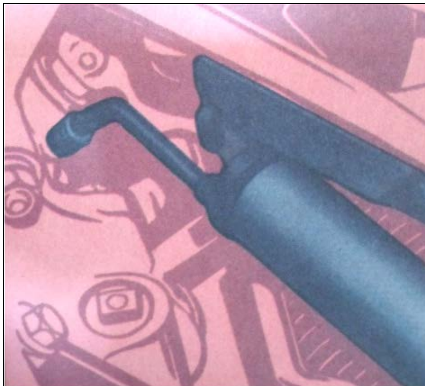
Рисунок 4.ОК-12 – Смазывание втулки вала вилки выключения сцепления через две пресс-масленки в опорах вала в картере сцепления
