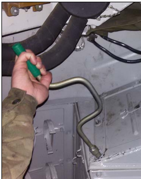
Рисунок 3.ОК-10 – Снятие щитка над коробкой передач в десантном отделении
