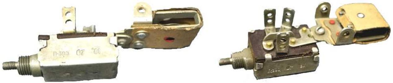
Рисунок 7.41 – Переключатель П300, внешний вид с разных сторон
