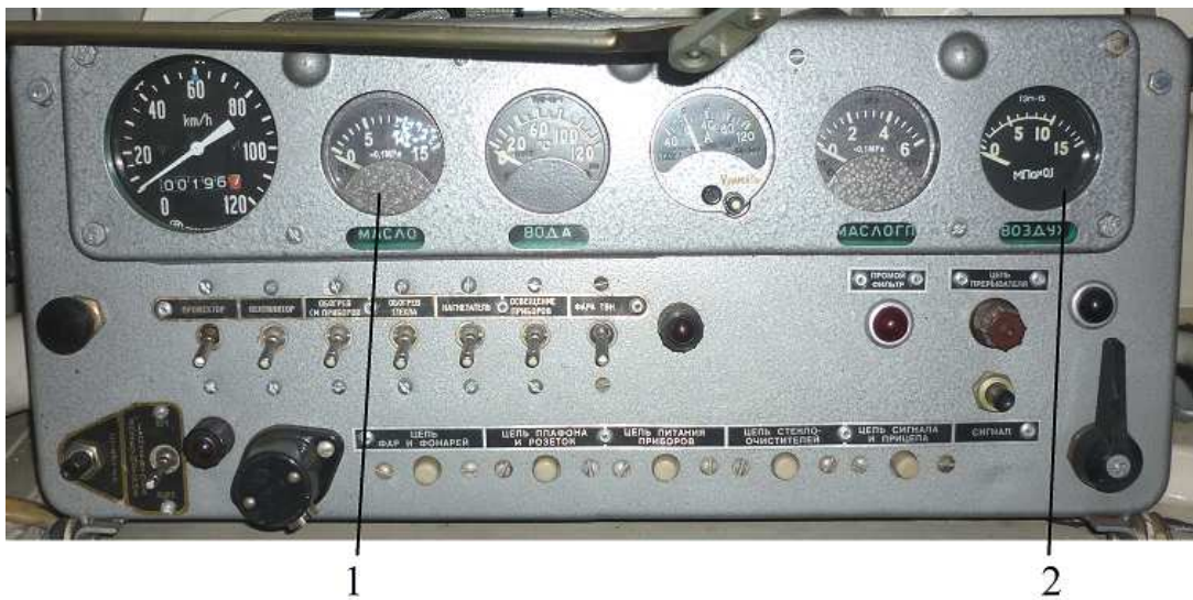
1 – указатель давления масла в смазочной системе двигателя; 2 – указатель давления воздуха в пневмосистеме
