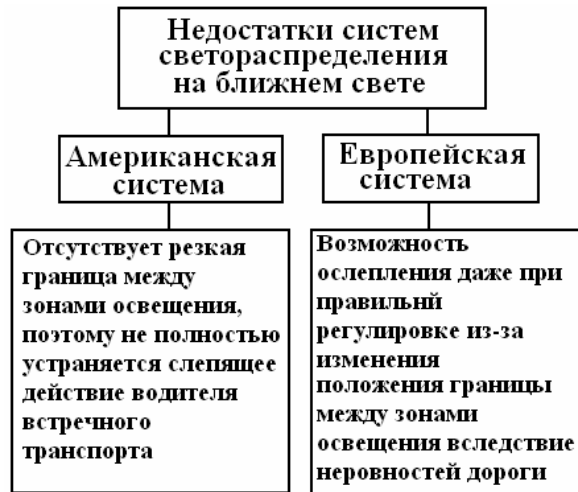
Рисунок 3.29 – Основные недостатки систем светораспределения света встречного разъезда
