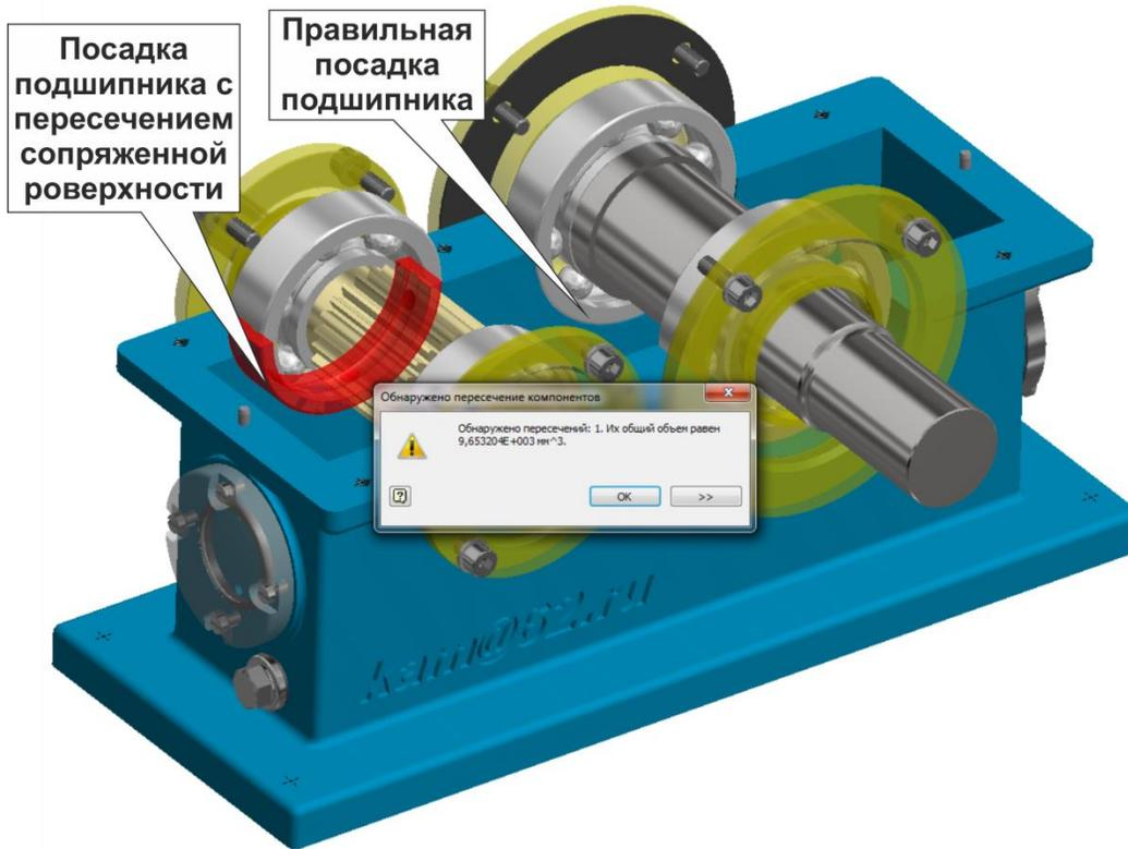
Рисунок 1 – Пример осуществления автоматической проверки пересечений статичных деталей
