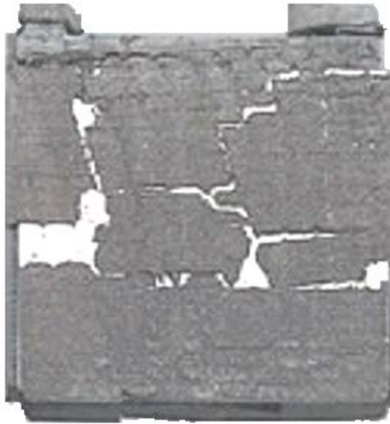
Рисунок 2.80 – Коррозионное разрушение положительного электрода вследствие эксплуатации в условиях перезаряда
