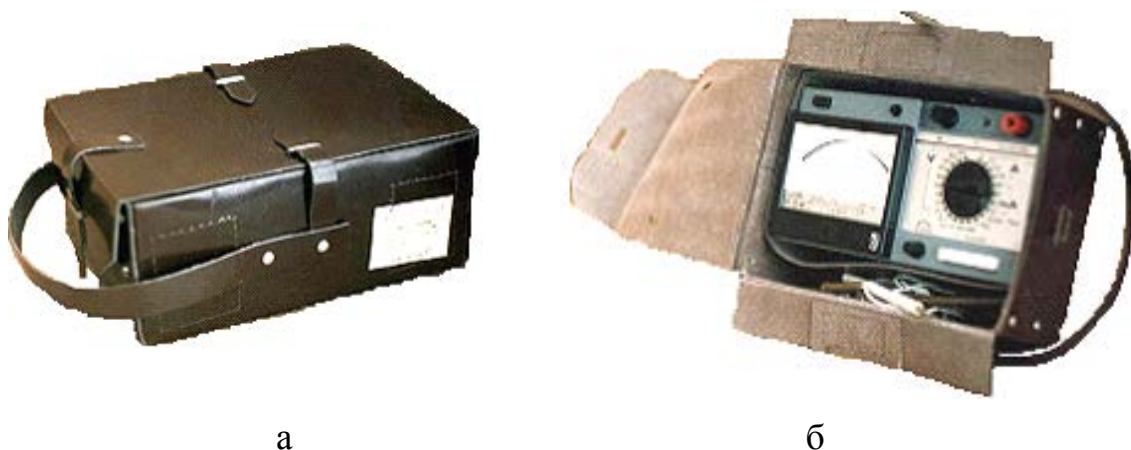
Рисунок 3.60 – Автотестер мод. К 484 с подсоединёнными стробоскопом, датчиками и зажимами
