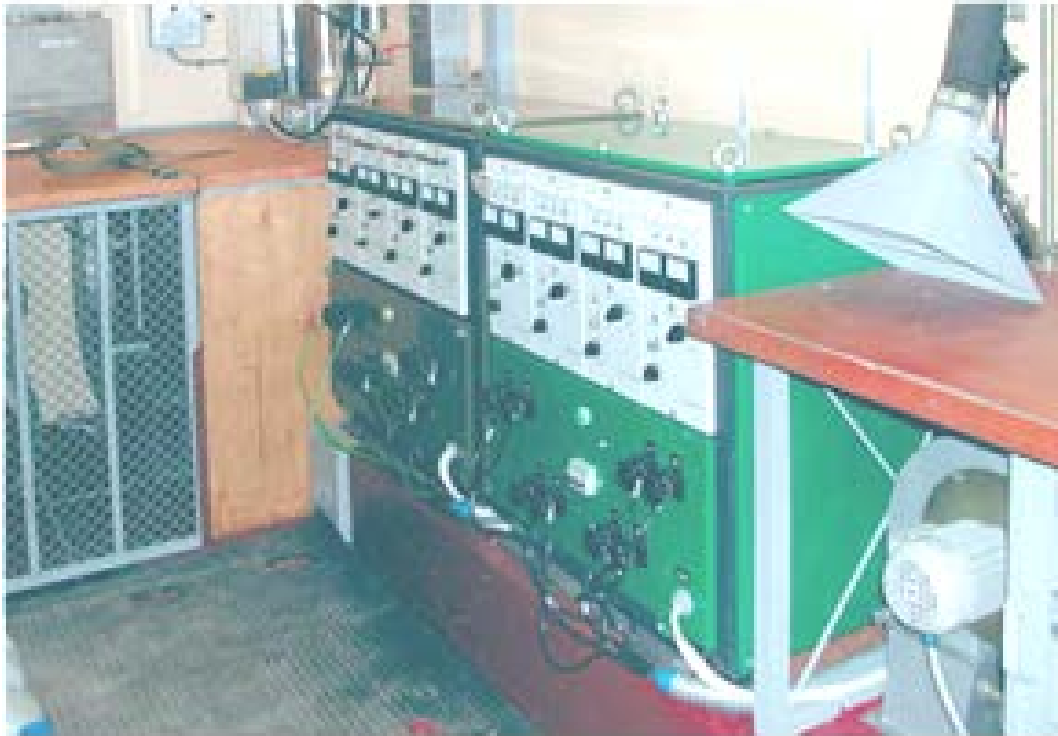
Рисунок 2.65 – Устройство зарядно-разрядное (ЗРУ) мастерской заряда и ремонта аккумуляторов МЗА-М2.1
