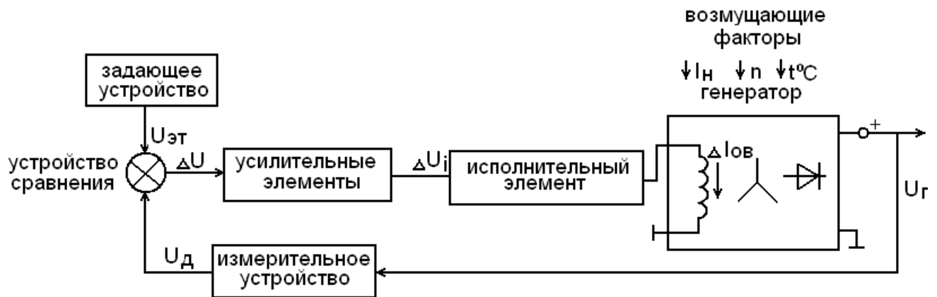
Рисунок 3.9 – Функциональная схема генераторной установки
