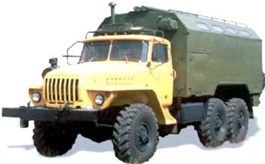
Рисунок 3.50 – Мастерская по ремонту электрооборудования МРЭ-АМ2.1 на шасси автомобиля Урал-4320-31
