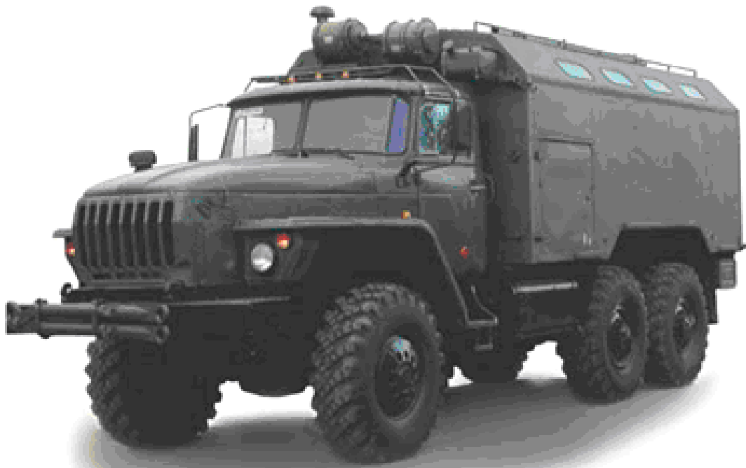
Рисунок 2.42 – Мастерская заряда и ремонта аккумуляторов МЗА-М2.1 на шасси Урал-4320-31
