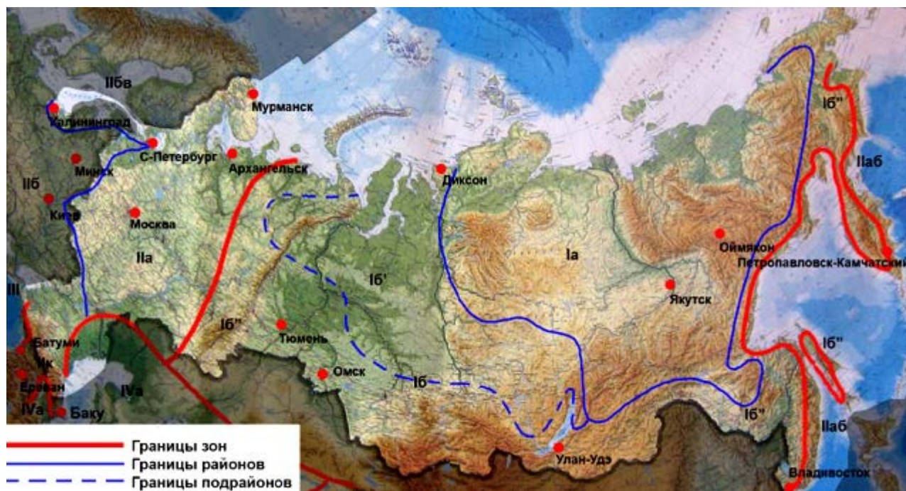
Рисунок 2.48 – Районирование территории Российской Федерации по воздействию климата на технические изделия и материалы
