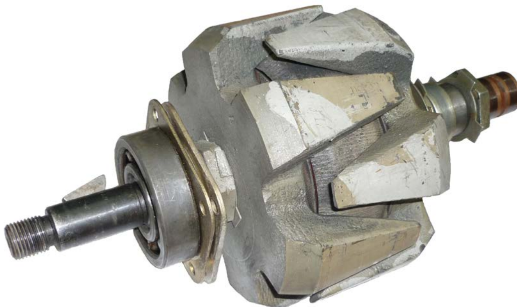
Рисунок 3.23 – Ротор генератора Г290 (Г290В) в сборе
