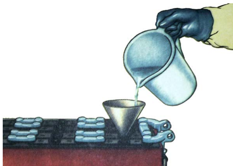
Рисунок 2.46 – Заливка электролита в батарею с помощью кружки и воронки
