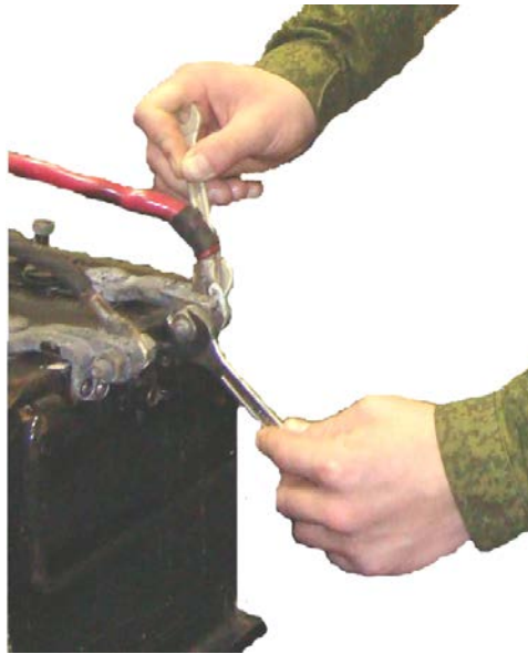
Рисунок 2.55 – Проверка крепления наконечников проводов к полюсным выводам батареи
