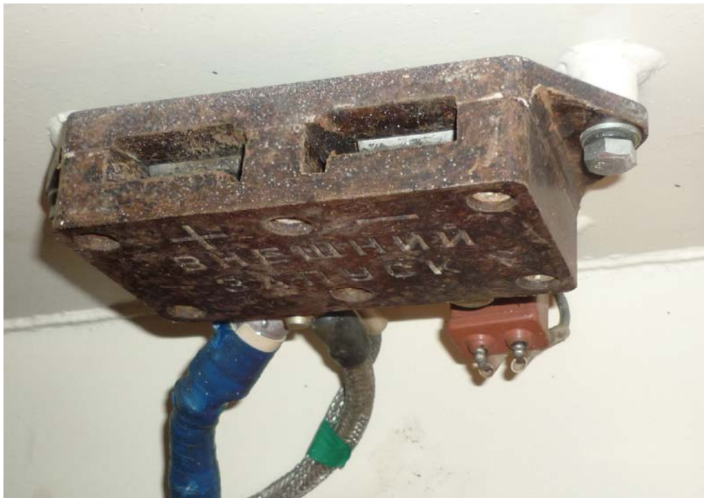
Рисунок 4.1 – Установка розетки внешнего пуска двигателя
