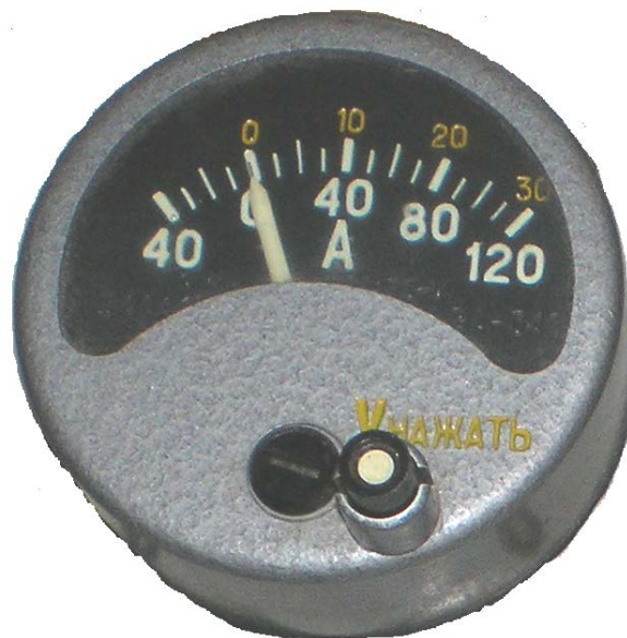
Рисунок 3.52 – Положение стрелки вольтамперметра при исправной генераторной установке в ходе проверки её работы
