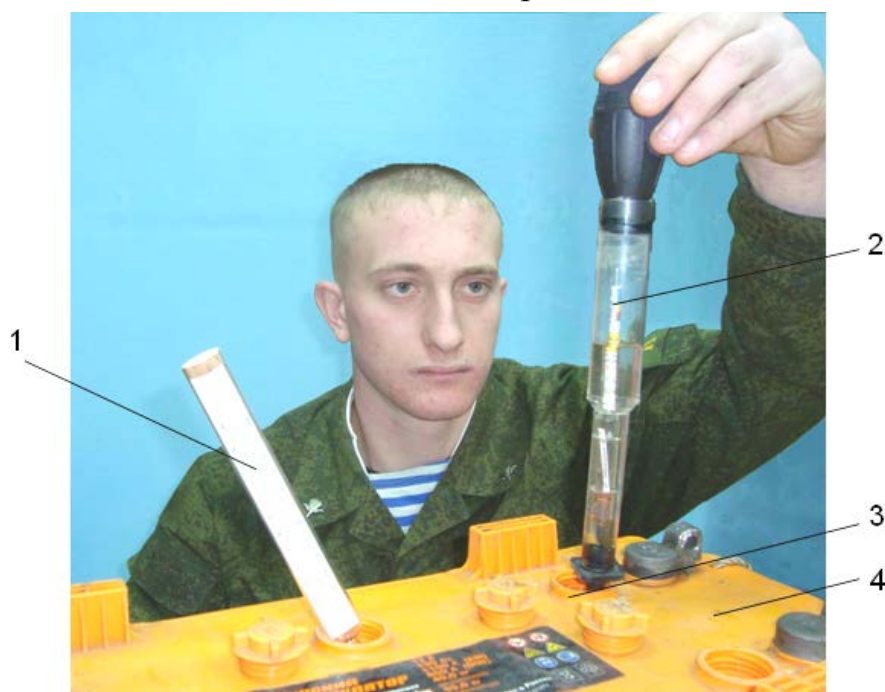
Рисунок 2.61 – Правильное положение зрачка глаза при измерении плотности электролита
