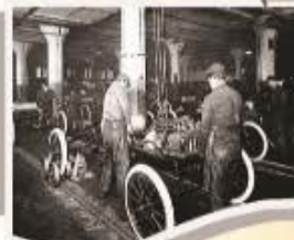
Конвейер Форда 1910-х: по машине каждые 10 секунд за 850$ (295$ в 1920)
