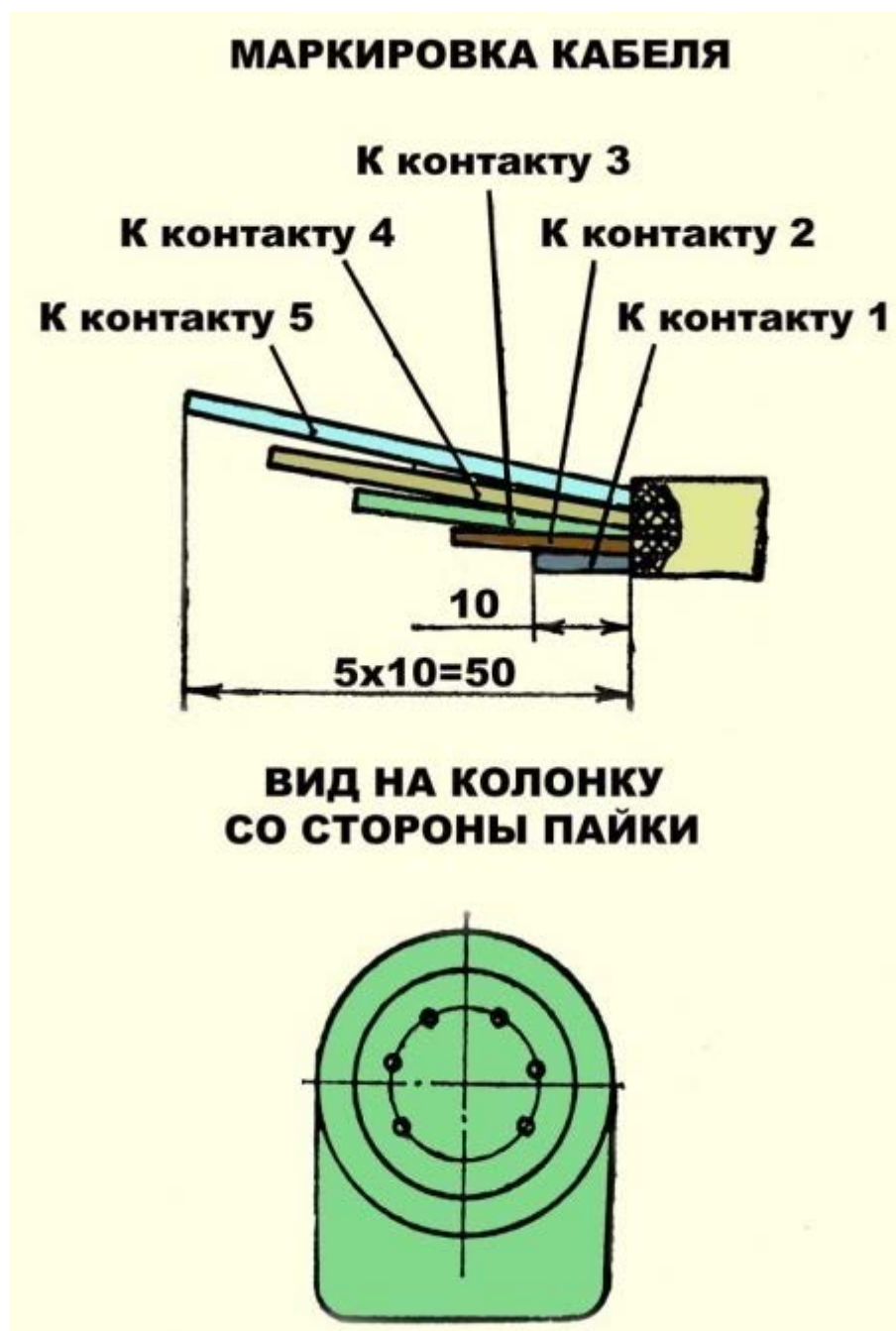
Рисунок 57 – Маркировка кабеля и вид на колодку со стороны пайки
