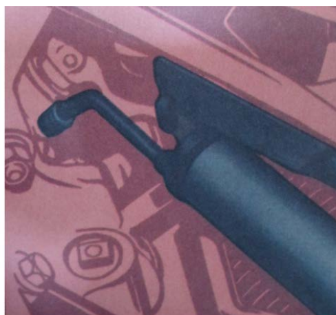
Рисунок 2.13 – Смазывание опоры вала вилки выключения сцепления
