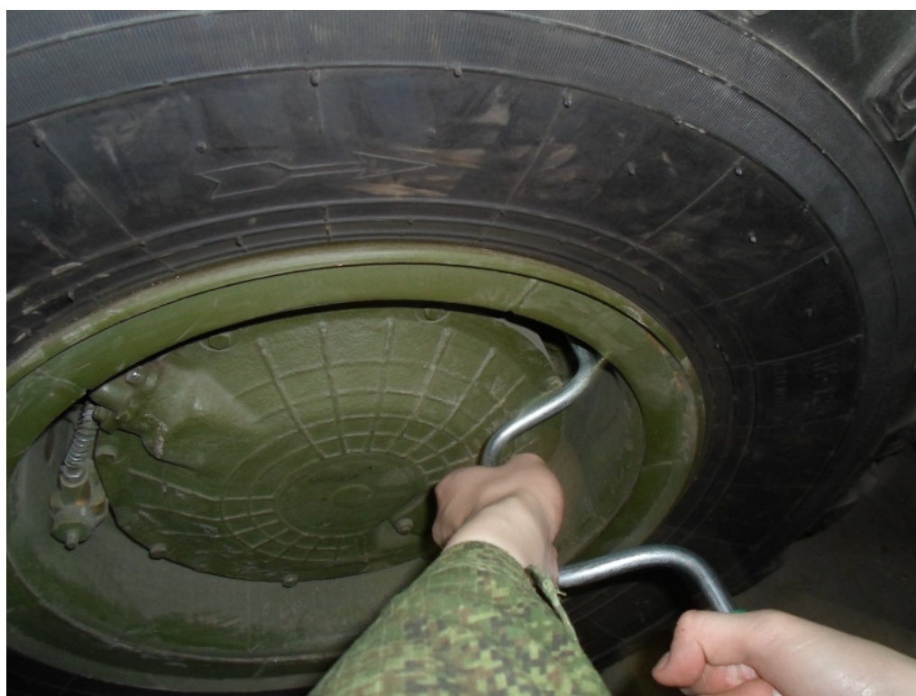
Рисунок 2.26 – Проверка затяжек гаек крепления колёс
