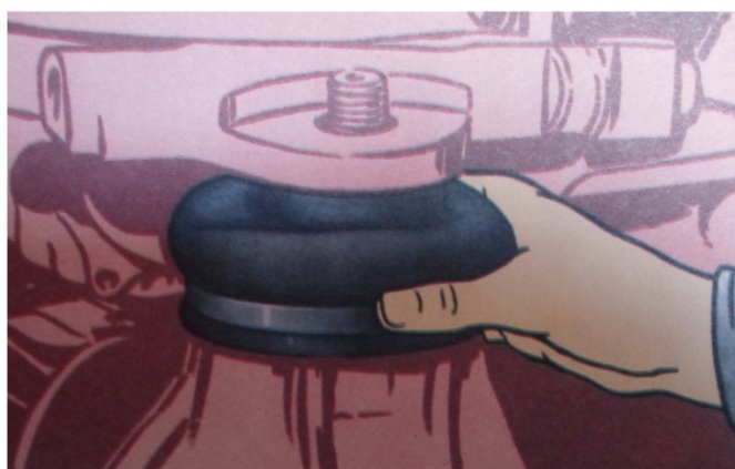
Рисунок 2.16 – Проверка состояния резиновых уплотнителей верхних шкворней на поворотных кулаках
