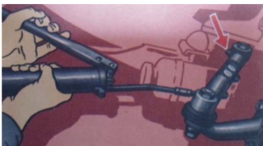
Рисунок 2.23 – Смазывание смазкой Литол–24 шарнирных соединений колёсных тяг рулевого привода
