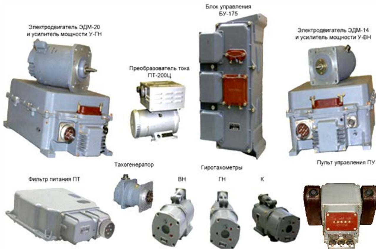
Рисунок 2.2 – Приборы, входящие в состав стабилизатора вооружения 2Э36-3
