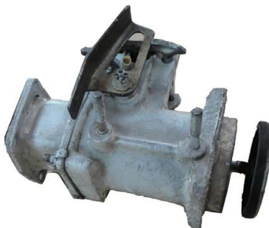
Рисунок 7.8 – Клапан вытяжного вентилятора
