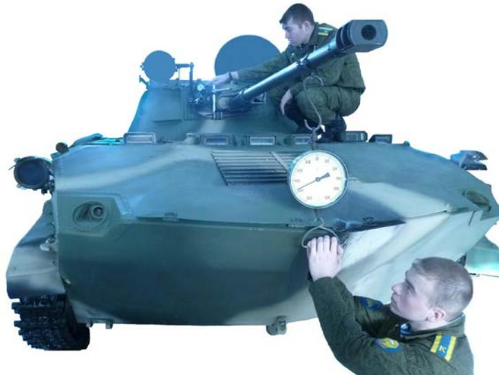
Рисунок 8.10 – Порядок проверки жесткости привода ВН
