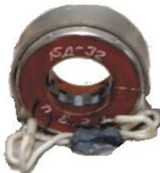
Рисунок 6.9 – Вращающийся трансформатор гиротахометра
