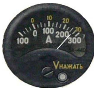
Рисунок 6.5 – Вольтамперметр ВА-440
