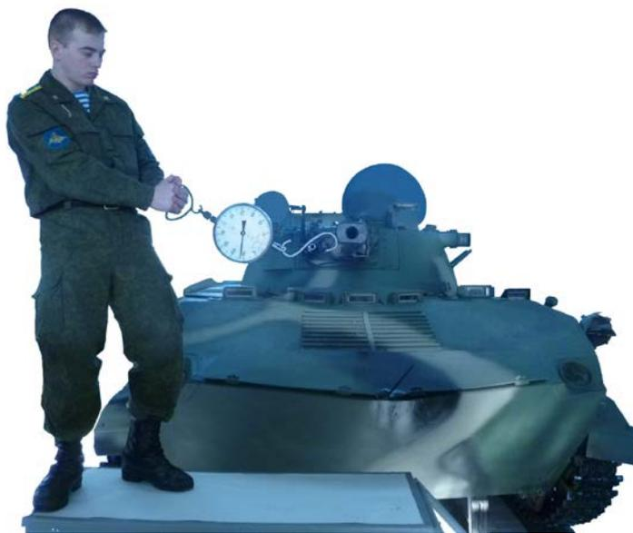
Рисунок 8.7 – Порядок проверки момента сопротивления поворота башни
