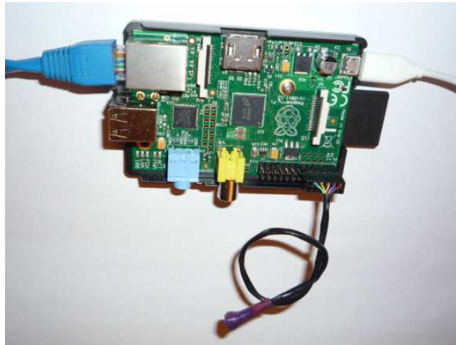
Рис. 12. Подключение датчика температуры к порту GPIO компьютера Raspberry Pi. Адрес датчика может устанавливаться в пространстве: 1001000 ... 1001111. Адрес подключенного датчика: 1001001 2 или 49 16 или 56 10 . Диапазон измерения датчика от -40°C до +125°C.
