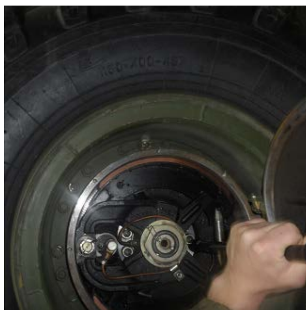
Рисунок 2.8 – Проверка и затяжка гайки крепления тормозных барабанов на шпильках ведомых шестерн колесных редукторов
