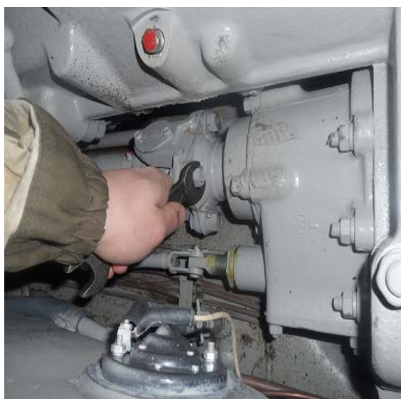
Рисунок 2.18 – Проверка затяжки болтов и гаек крепления фланцев карданных валов.
