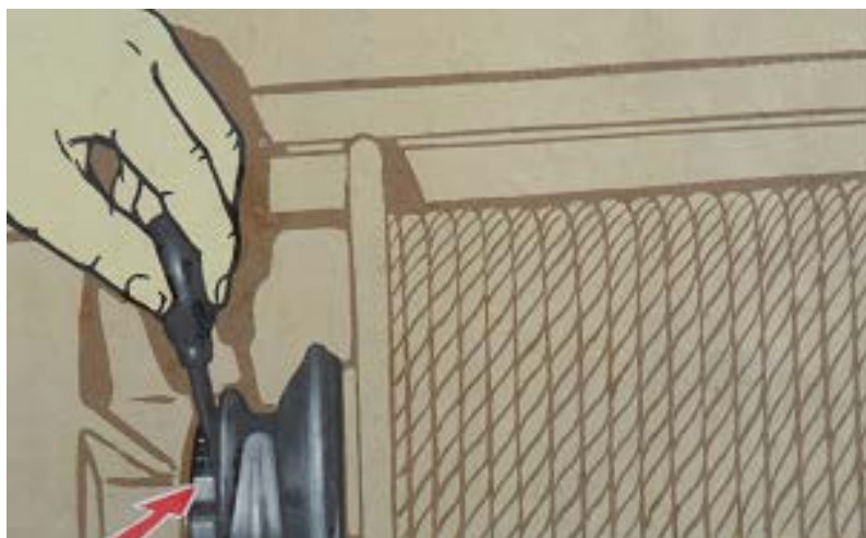
Рисунок 2.36 – Смазка маслом МТ-16П, шлицов скользящей муфты выключения лебёдки.
