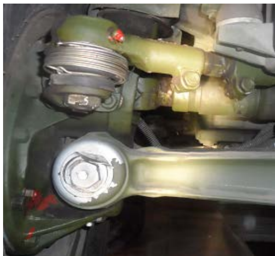
Рисунок 2.25 – Затяжка резиновых втулок верхних и нижних рычагов подвески
