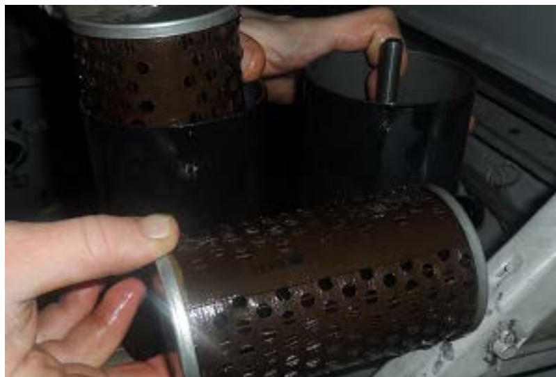
Рисунок 2.9 – Замена фильтра тонкой очистки топлива.
