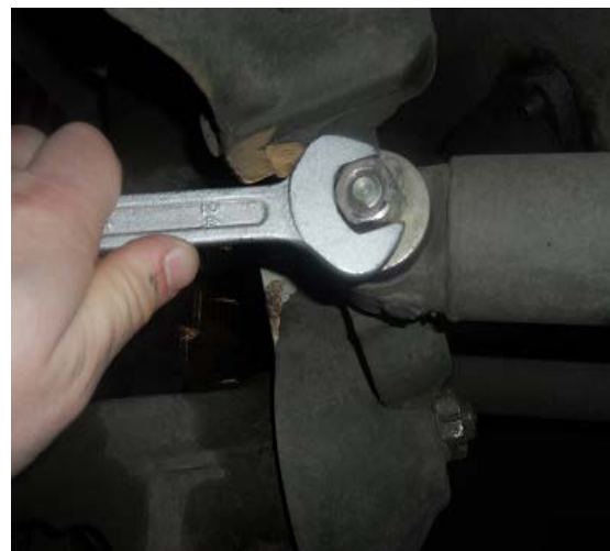
Рисунок 2.25 – Затяжка резиновых втулок верхних и нижних рычагов подвески
