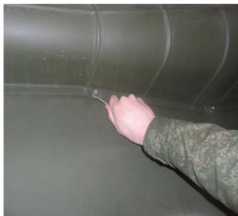
Рисунок 2.17 – Выпускные трубы и их подтяжка
