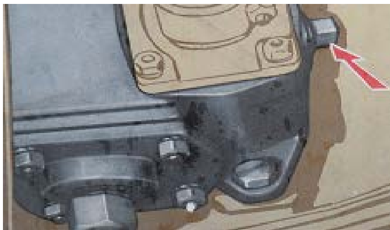
Рисунок 2.37 – Замена масла в картере рулевого механизма
