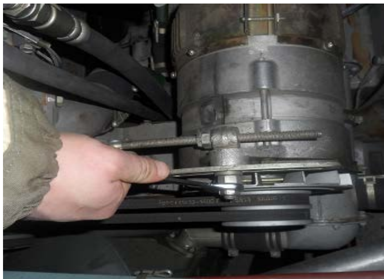
Рисунок 2.29 – Проверка крепления генераторов
