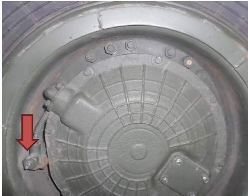
Рисунок 2.33 – Подтяжка гайки крепления колес в зоне трубки подвода воздуха к колесному кранику
