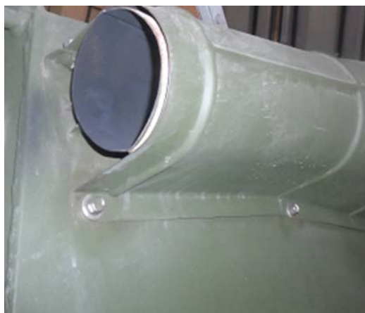
Рисунок 2.17 – Выпускные трубы и их подтяжка
