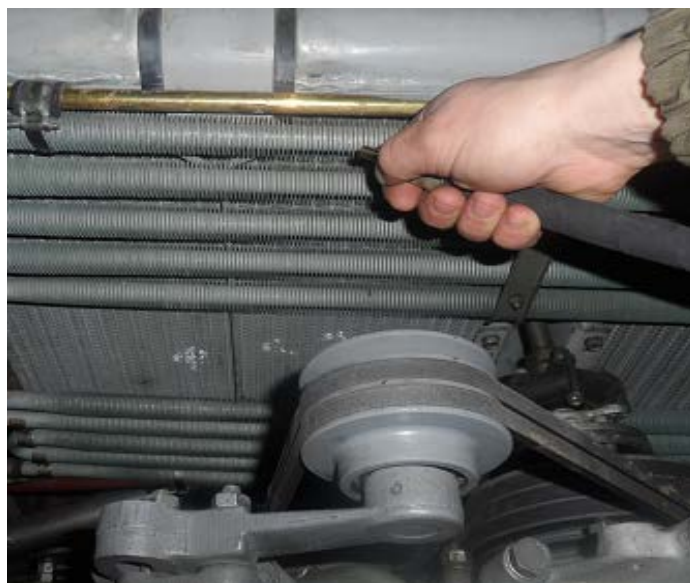
Рисунок 2.11 – Продувка сжатым воздухом радиаторов
