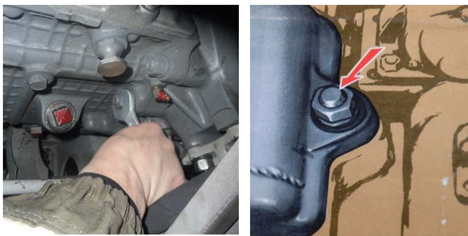
Рисунок 2.15 – Подтяжка болтов крепления коробки передач и раздаточной коробки
