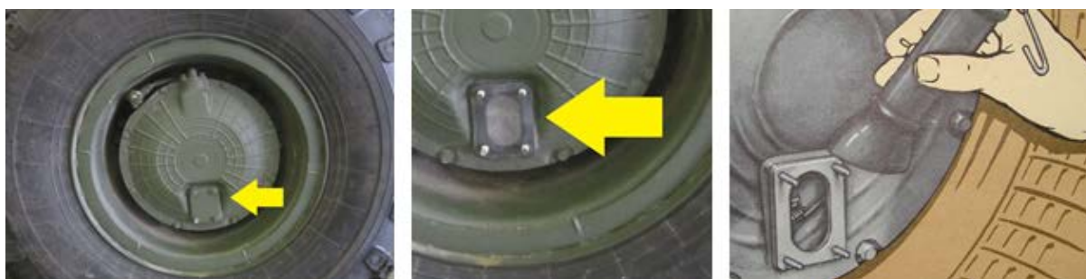
Рисунок 2.19– Проверка отсутствия воды и масла в тормозных барабанах
