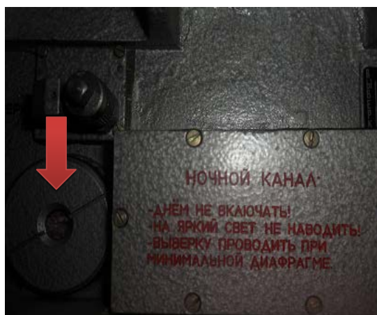
Рисунок 2.7 – Окно для определения окраски патрона влагопоглотителя
