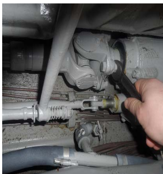
Рисунок 2.18 – Проверка затяжки болтов и гаек крепления фланцев карданных валов.
