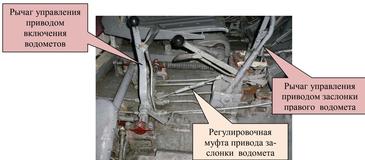
Рисунок 1.40 – Рычаг включения водометов
