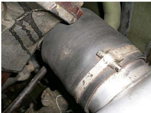
Рисунок 1.22 – Шланг, соединяющий раздаточную трубу с впускными коллекторами двигателя.
