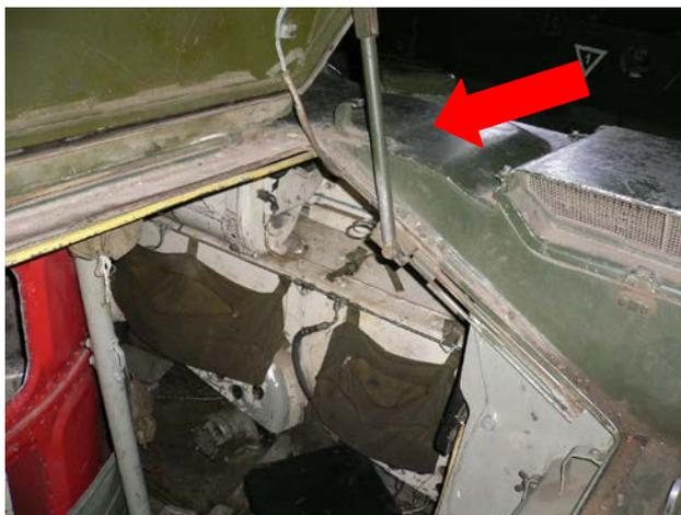
Рисунок 1.32 – Стопор крышки посадочного люка
