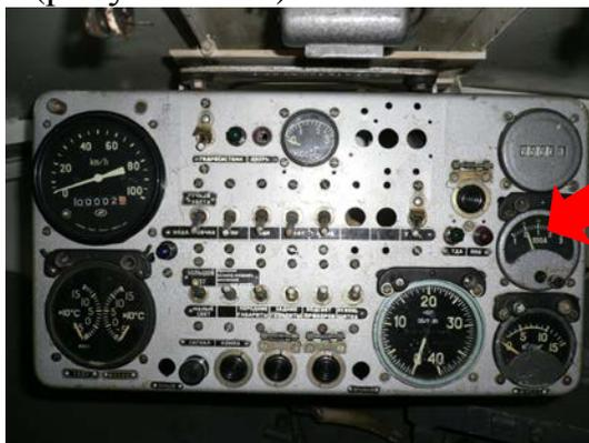
Рисунок 1.53 – Сигнальный фонарь контроля исправности системы ППО
