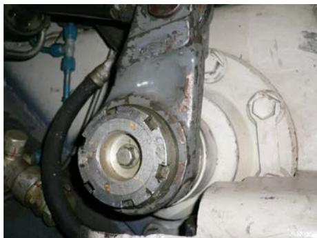
Рисунок 1.13 Кривошип механизма натяжения гусеницы.
