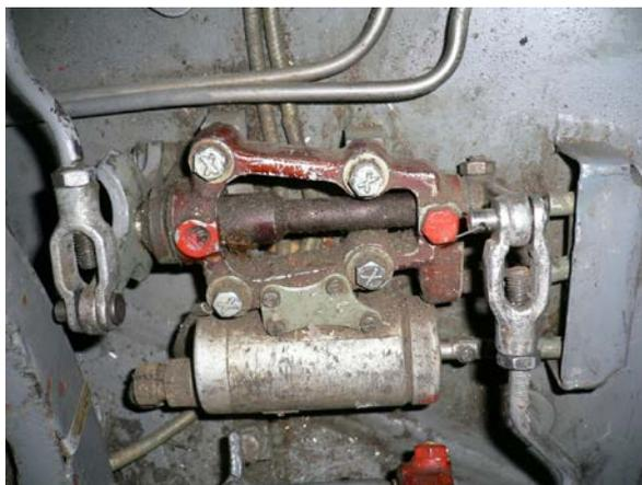
Рисунок 1.56 –Точки смазки приводов управления
