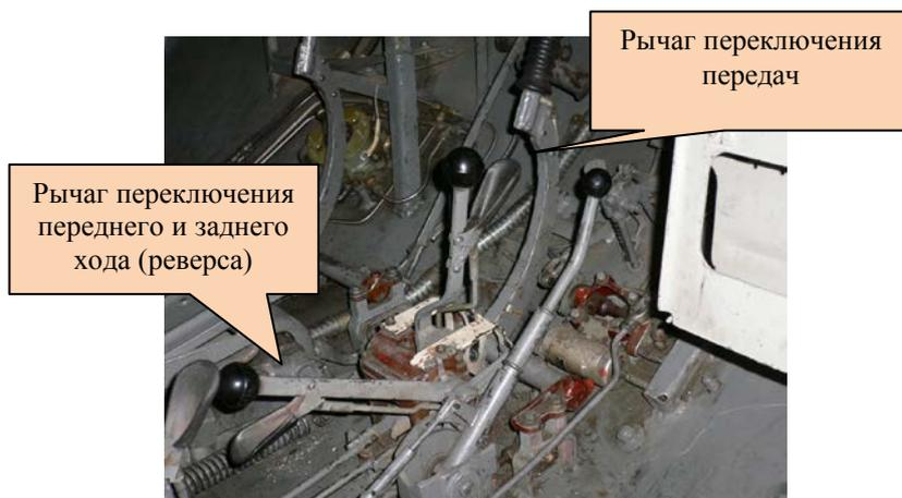
Рисунок 1.39 – Рычаг привода управления коробкой передач трансмиссии
