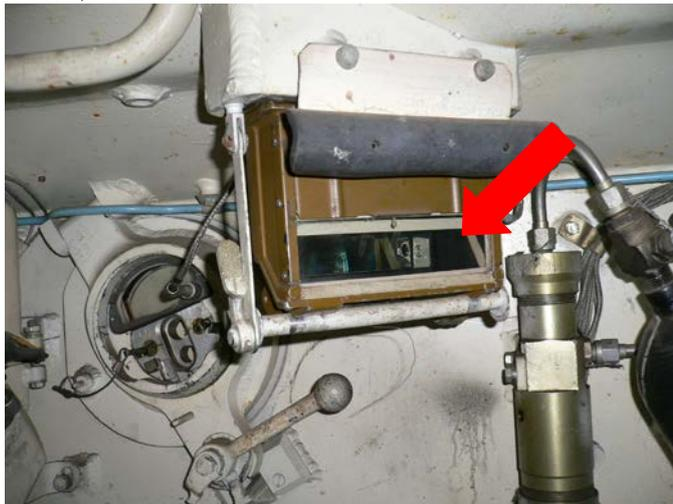
Рисунок 1.29 –т Приборы наблюдения расположенные в среднем отделении
