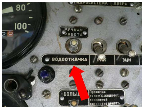
Рисунок 1.25 – Переключатель рода работы водооткачивающих насосов (при положении вниз работа происходит автоматически)
