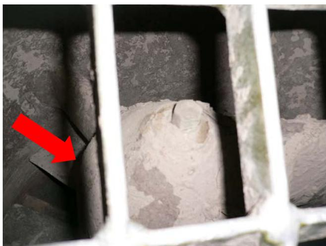
Рисунок 1.42 – Приемный патрубок водометного движителя.
