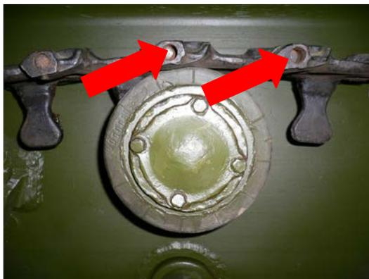
Рисунок 1.8 – Проверить состояние траков и пальцев гусениц, а также наличие пробок стопорных пальцев
