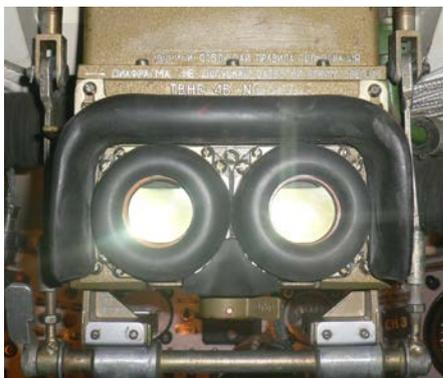
Рисунок 1.54 – Прибор ТВНЕ-4Б
