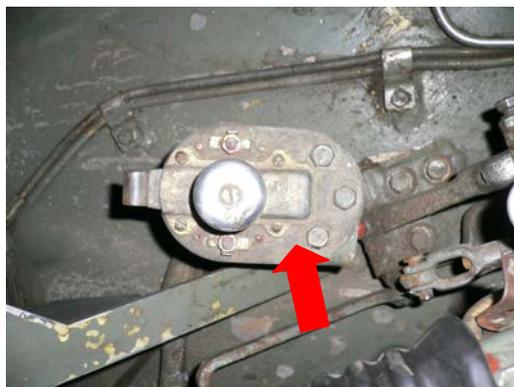
Рисунок 1.47 – Крепление выключателя аккумуляторной батареи
