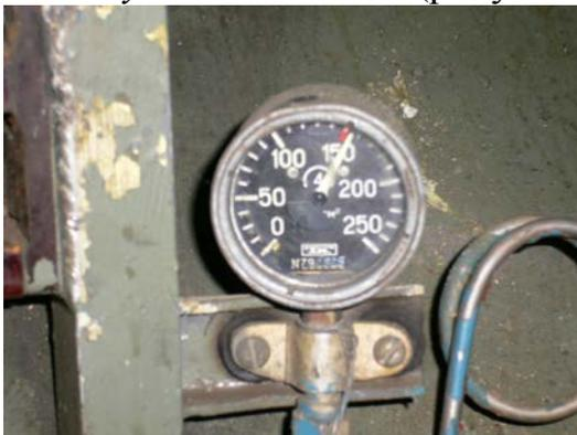
Рисунок 1.44 – Контрольный манометр давления воздуха в баллонах системы воздушного пуска двигателя
