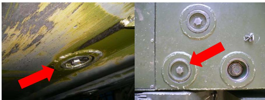
Рисунок 1.6 – Проверка наличия и плотности затяжки всех крышек люков и пробок корпуса машины и башни
