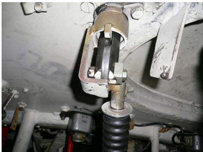
Рисунок 1.35 – Замковое устройство люка механика-водителя
