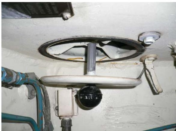
Рисунок 1.31 – Механизм открывания и закрывания клапанов воздухозаборника двигателя
