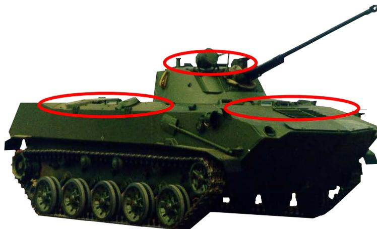
Рисунок 1.5 – Мойка БМД-2, очистка от грязи, проверка корпуса машины на наличие повреждений
