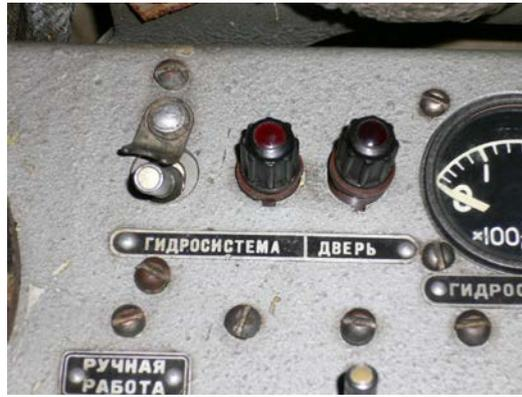
Рисунок 1.10 – Выключатель ГИДРОСИСТЕМА.
