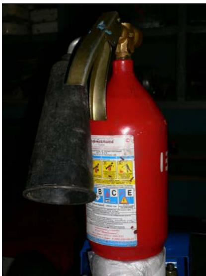
Рисунок 1.33 – Огнетушитель углекислотный ОУ-2
