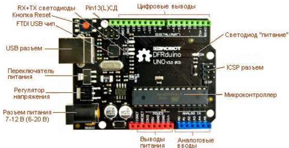
Рис. 2. Периферия платформы ARDUINO (DFRduino) UNO.
