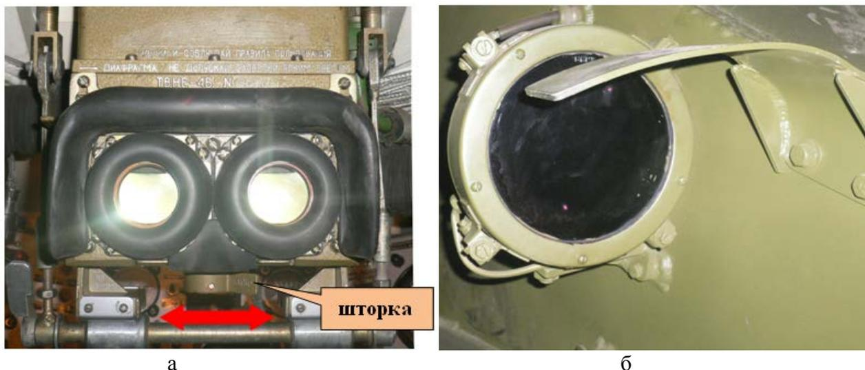
а – прибор ночного видения механика-водителя ТВНЕ-4Б в рабочем положении; б – фара ФГ-125 инфракрасного света (спереди справа по ходу движения машины)
