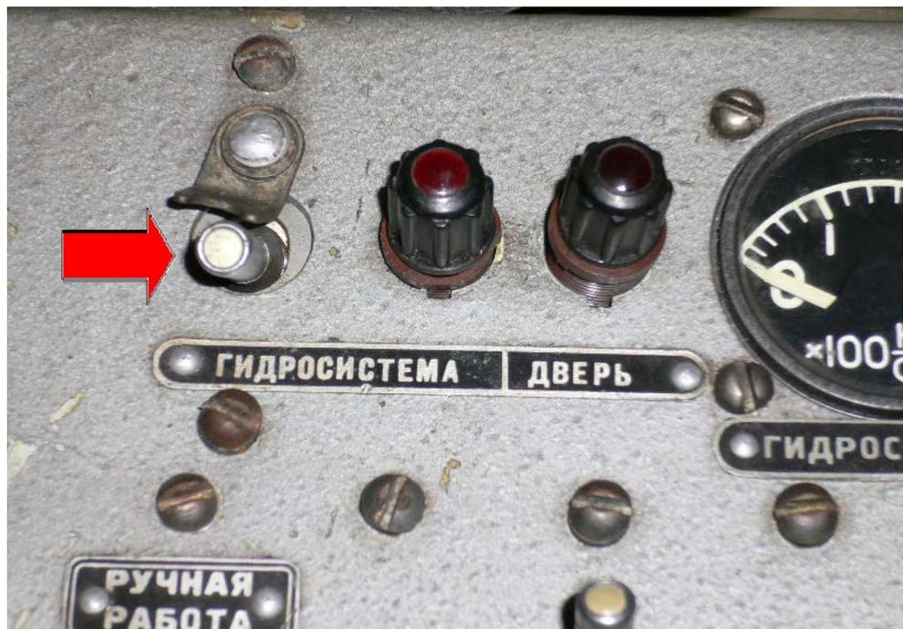
Рисунок 1.11 – Выключатель ГИДРОСИСТЕМА на щитке механика-водителя
