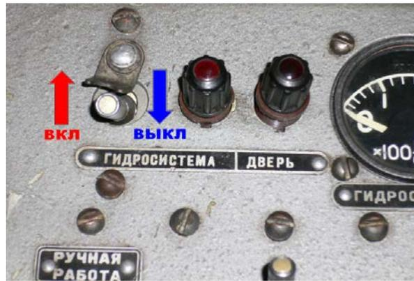
Рисунок 1.22 – Выключатель ГИДРОСИСТЕМА
