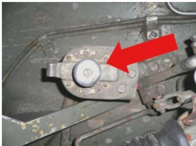
Рисунок 1.12 – Выключатель аккумуляторной батареи
