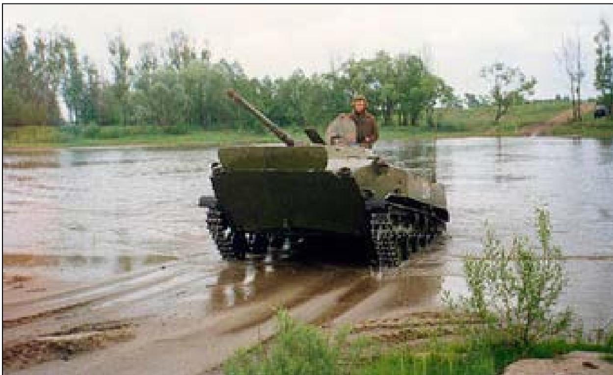
Рисунок 1.39 Проверка на плаву герметичности корпуса машины.
