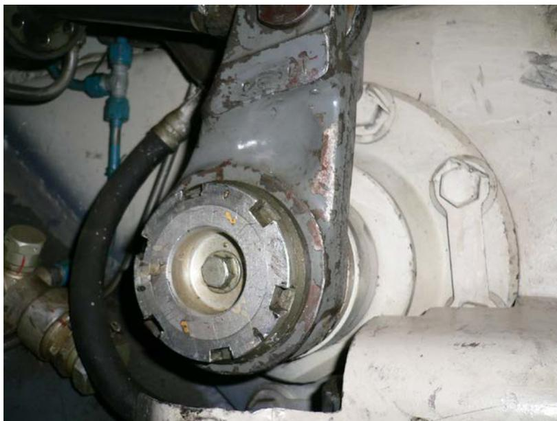
Рисунок 1.24 – Кривошип механизма натяжения гусеницы.
