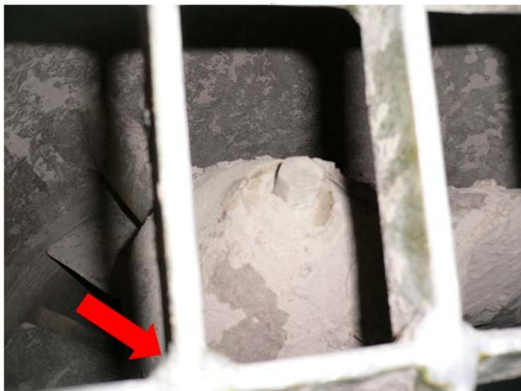
Рисунок 1.31 – Приемный патрубок водометного движителя.
