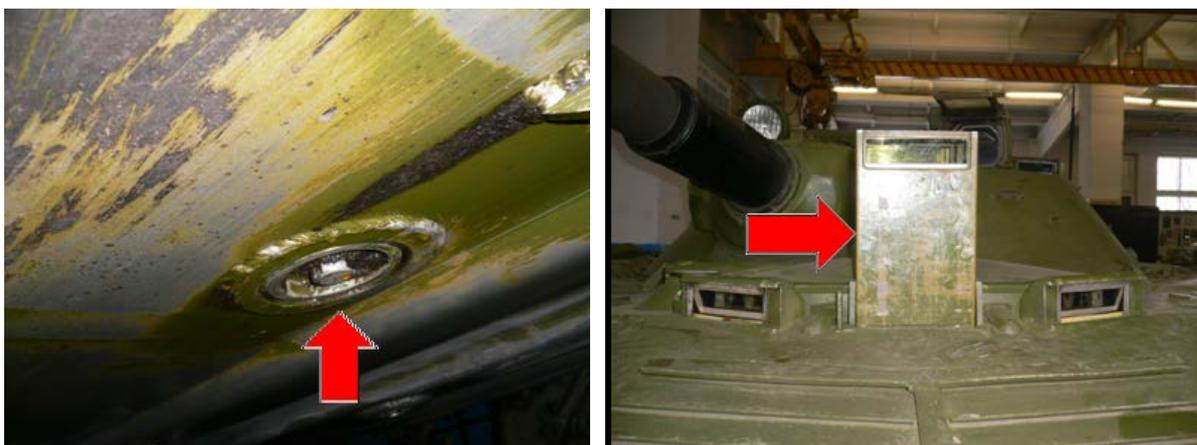
Рисунок 1.40 – Сливные отверстия на днище машины для удаления воды. Обслуживание смотровых приборов после преодоления водной преграды.
