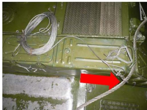
Рисунок 1.35 – Укладка и закрепление буксирного троса на машине (впереди и сзади) при преодолении водной преграды.
