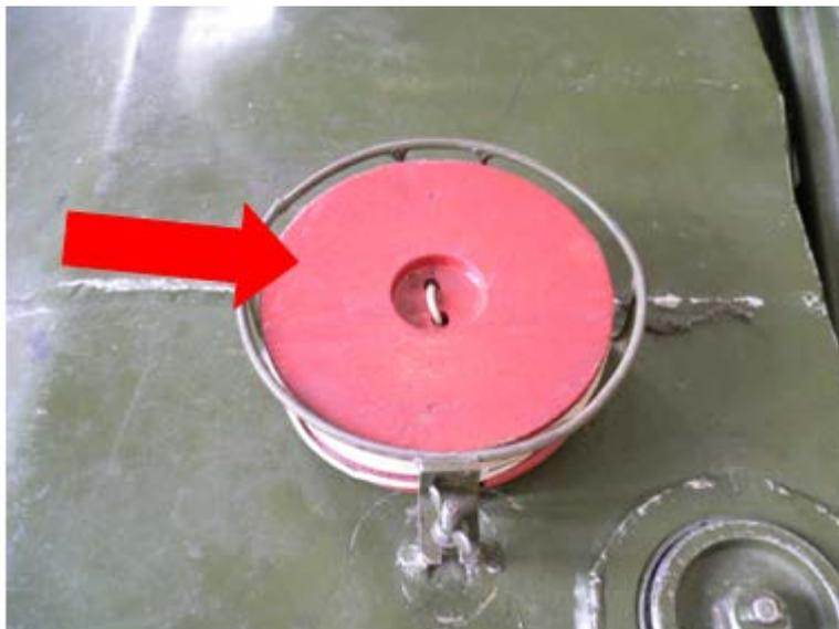
Рисунок 1.36 – Закрепление спасательного буйа на машине перед преодолением водной преграды.
