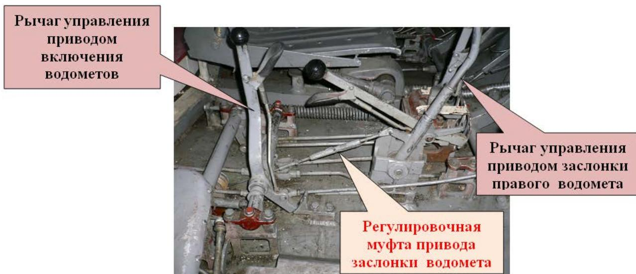
Рисунок 1.29 – Рычаг включения водометов
