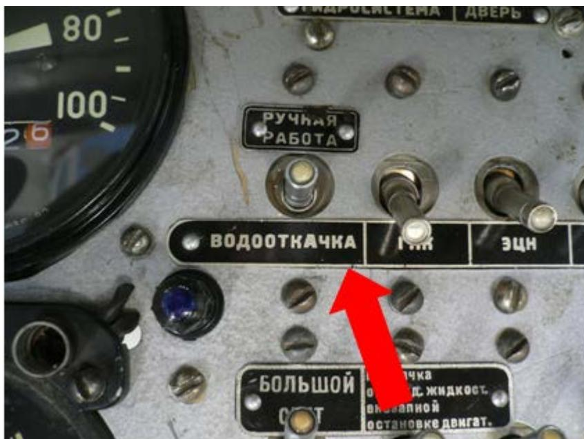
Рисунок 1.33 – Переключатель рода работы водооткачивающих насосов (при положении вниз работа происходит автоматически)
