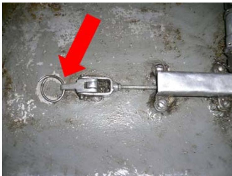
Рисунок 1.32 – Управляемый клапан для обеспечения перетекания воды из среднего отделения в моторно-трансмиссионное в нижней части моторной перегородки
