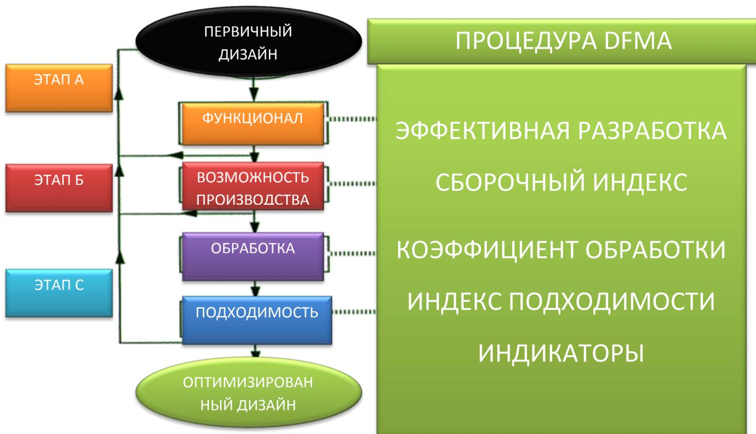
Рис. 68<sup>1</sup> – Базисные элементы Разработки для производства и сборок
