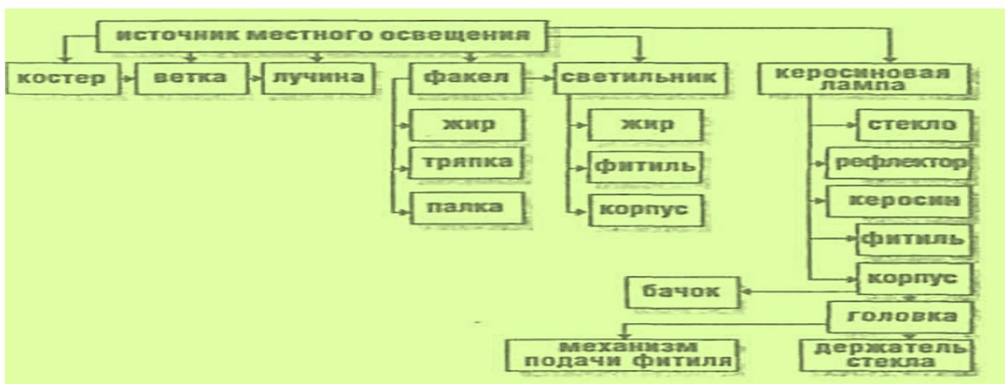
Рис. 73<sup>1</sup> – Пример совершенствования технологии и компонентов по ТРИЗ
