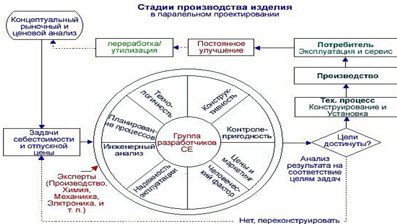
Рис. 71<sup>1</sup> – Схема Конкурентного (параллельного) инжиниринга
