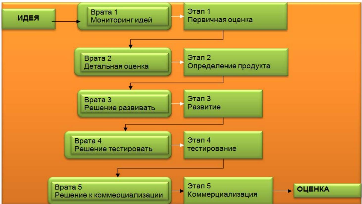
Рис. 34<sup>1</sup> – Упрощенная схема Stage-Gate процесса
