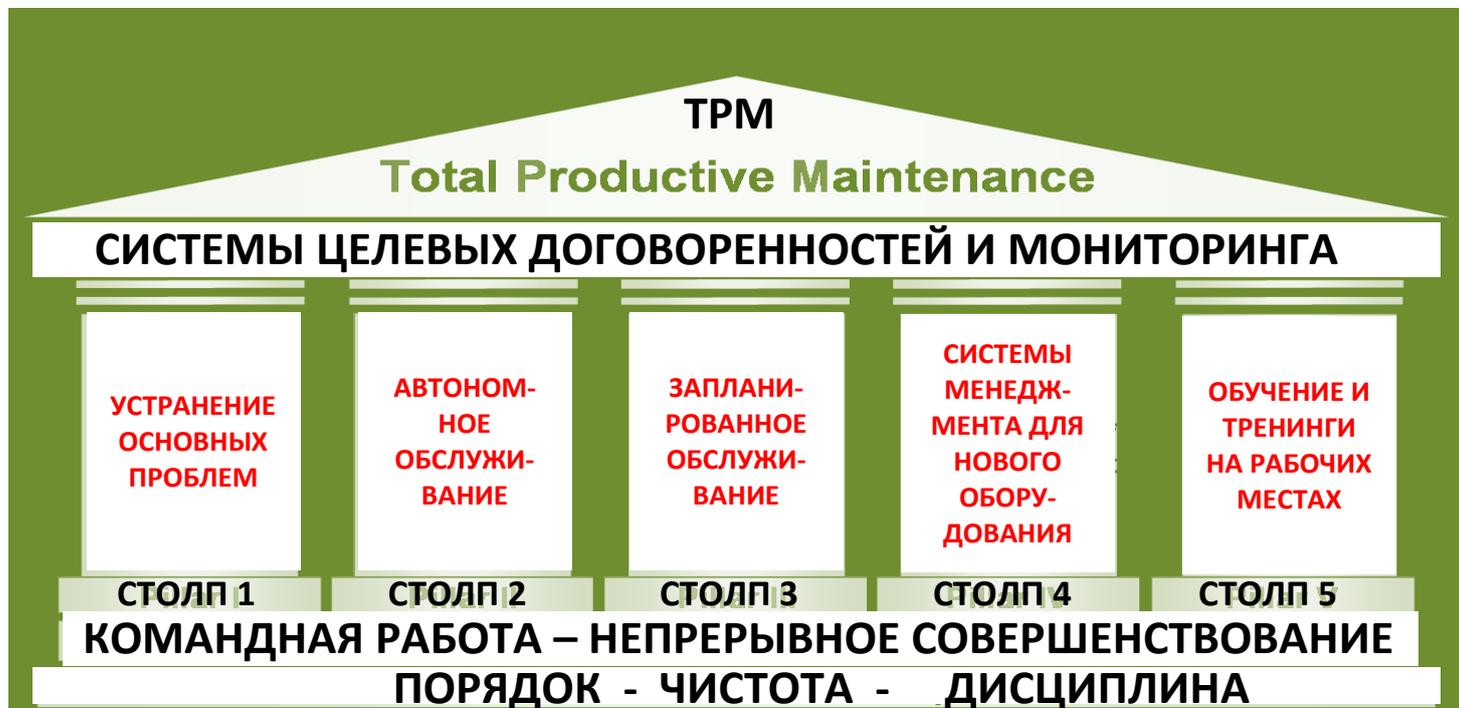
Рис. 65<sup>1</sup> – Базисные принципы системы TPM по системе 5 принципов
