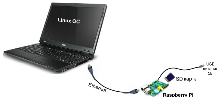
Рис. 6. Вариант работы с Raspberry Pi как с консолью сетевого компьютера.
