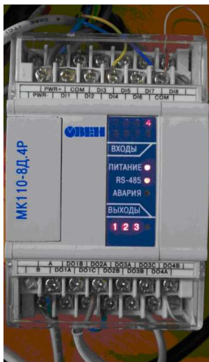
Рис. 2. Вид подключенного МК 110 и параметры обмена по RS-485.
