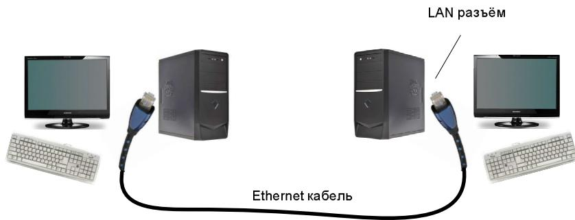
**Рис. 9.** Проводное соединение компьютеров через LAN интерфейсы и Ethernet кабель.
