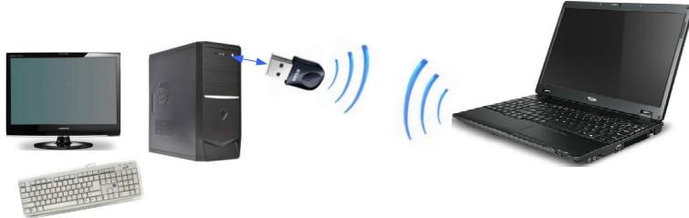
**Рис. 3.** Беспроводное сетевое соединение компьютеров через встроенный и внешний (например, D-Link) Wi-Fi адаптеры..
