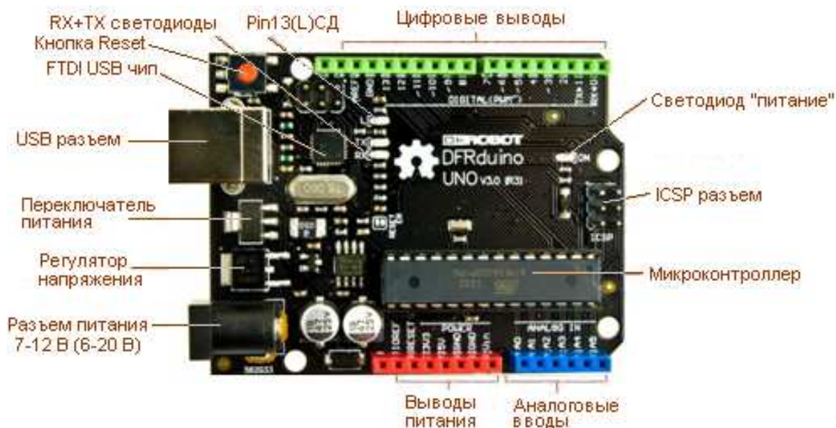
Рис. 1. Периферия платформы ARDUINO (DFRduino) UNO R3. Цифровые выходы, поддерживающие работу в режиме ШИМ обозначены на плате волнистой линией ~. AREF вывод опорного напряжения АЦП (используется с функцией analogReference()).
