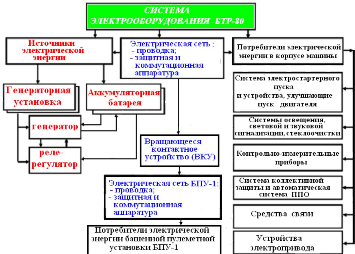
Рисунок 2 – Структурная схема электрооборудования БТР-80
