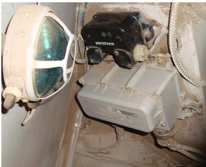
Рисунок 3 – Размещение реле-регулятора РР390-Б1 на БТР-80
