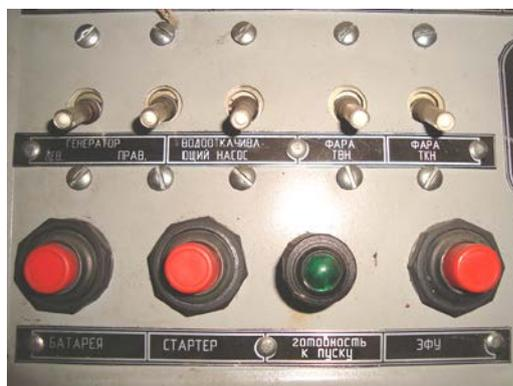
Рисунок 4 – Кнопка СТАРТЕР на щитке приборов БТР-80
