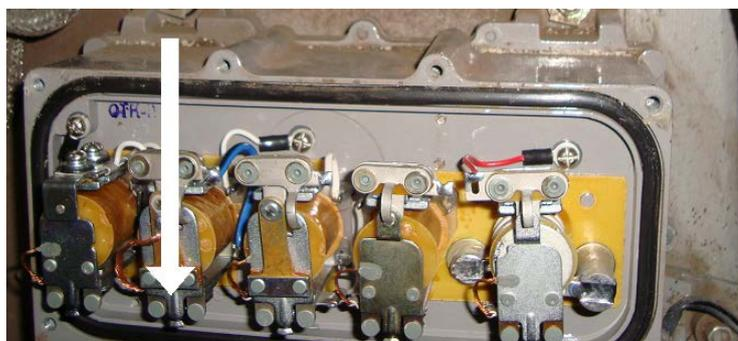
Рисунок 6 – Электростартерный пуск дизеля путем замыкания вручную контактов одного из реле стартера
