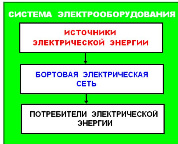
Рисунок 1 – Функциональная схема электрооборудования БТР-80
