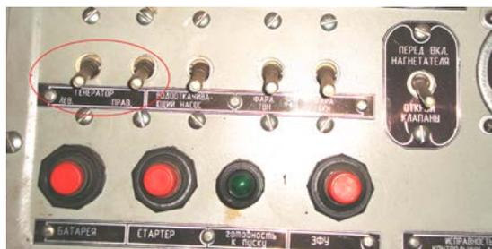
Рисунок 4 – Выключатели ПРАВ. ГЕНЕРАТОР и ЛЕВ. ГЕНЕРАТОР
