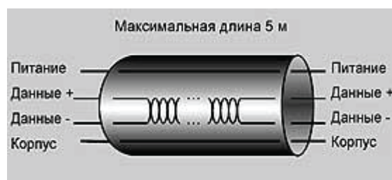
Рис. 4. Структура USB кабеля. Сигнальные линии кабеля должны быть выполнены в виде экранированной витой пары с импедансом 90 Ом.
