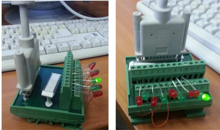
**Рис. 9.** Циклическое включение светодиодов - результат работы выполненного примера управления LPT портом.
