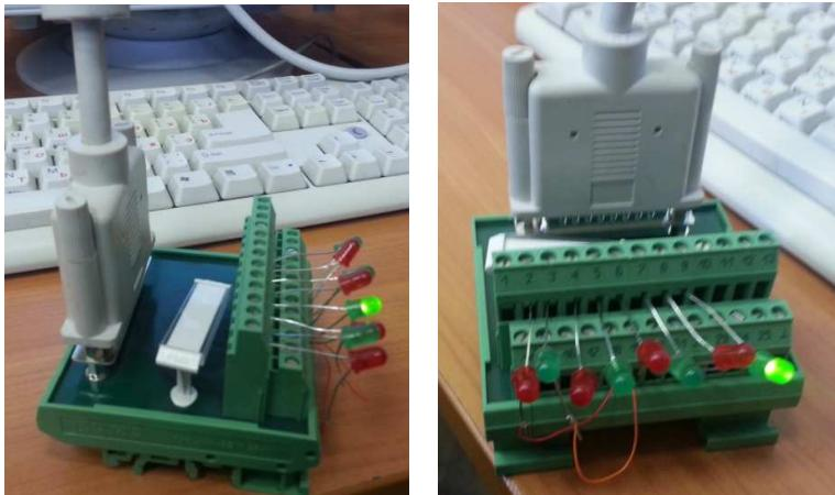
**Рис. 9.** Циклическое включение светодиодов - результат работы выполненного примера управления LPT портом.
