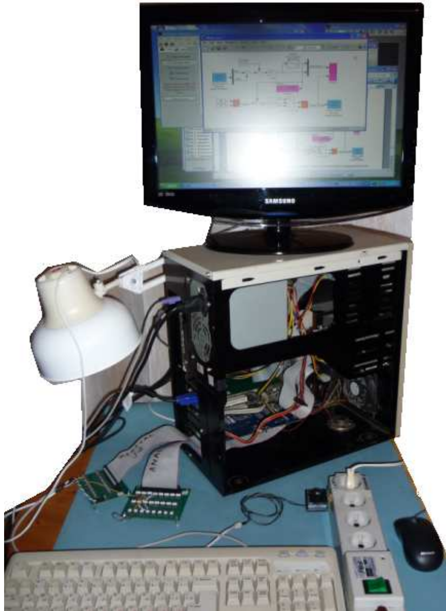
Рис. 13. Элементы системы термостатирования на базе интерфейса Sensoray Model 626.
