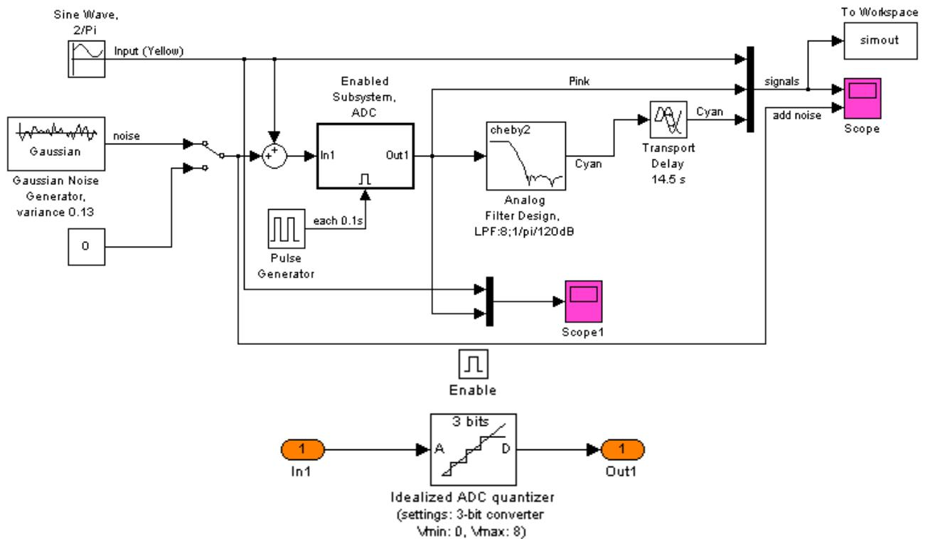
**Рис. 1.** Пример модели АЦП (с субблоком) в Simulink. Ключ на выходе источника шума позволяет отключить источник от входа АЦП для наблюдения эффекта передискретизации на выходе фильтра.
