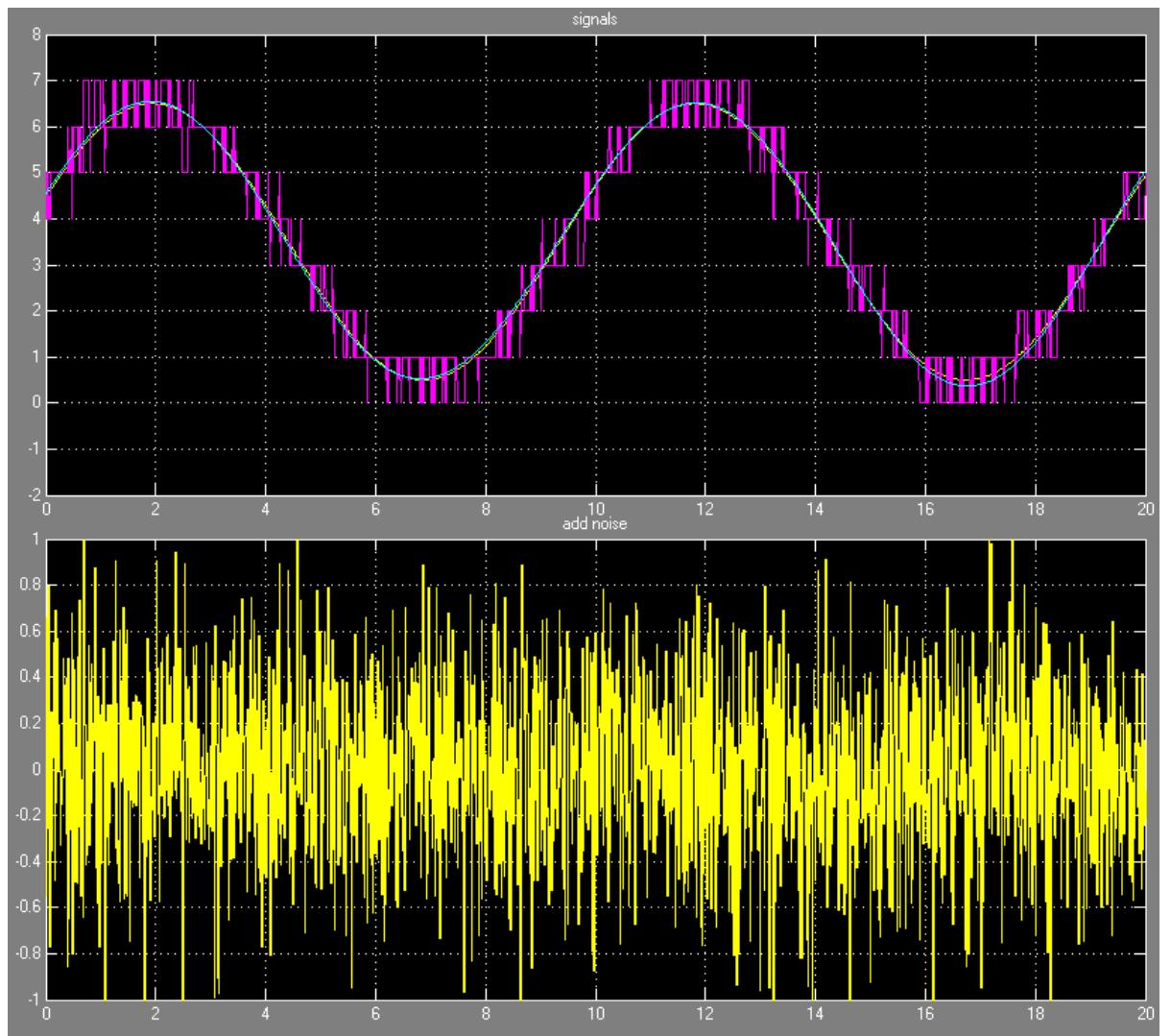
**Рис. 3.** Сигналы модели дизеринга. На верхней диаграмме: входной сигнал (желтый), выходной сигнал АЦП без фильтрации (малиновый) и выходной сигнал фильтра (голубой). На нижней диаграмме показан шум, добавленный ко входному сигналу.
