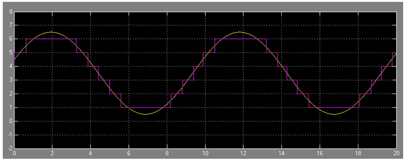
**Рис. 2.** Входной незашумленный сигнал (желтый) и выходной сигнал АЦП (розовый)
