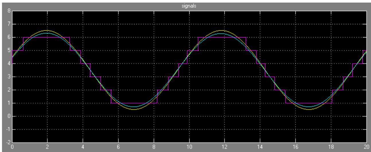
**Рис. 4.** Сигналы модели передискретизации. Входной сигнал (желтый), выходной сигнал АЦП с шумом квантования (малиновый) и отфильтрованный сигнал с улучшенным отношением сигнал/шум (голубой).
