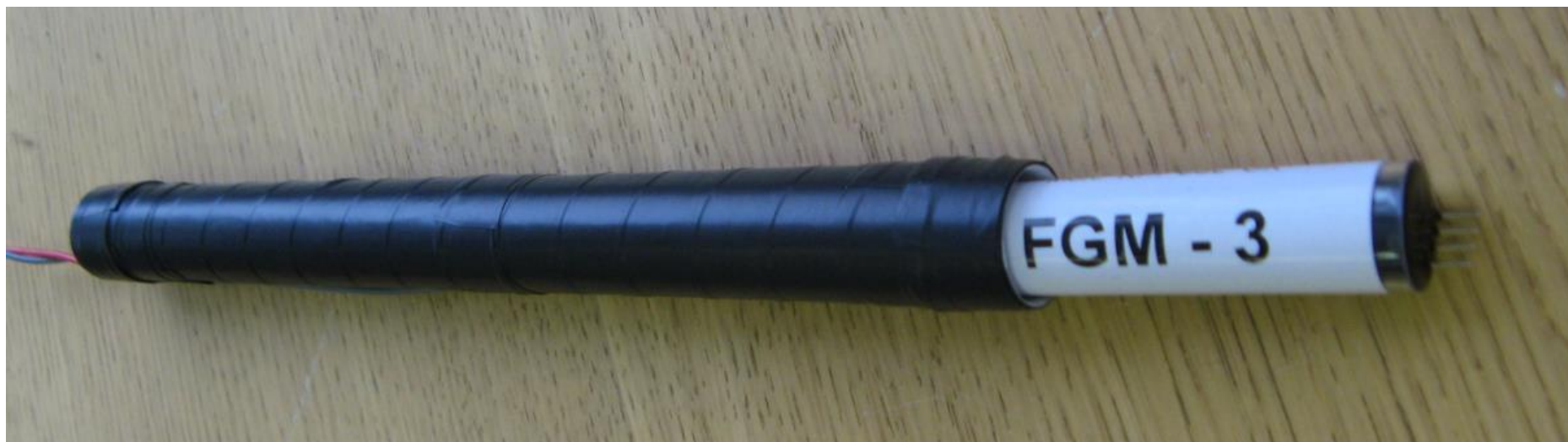
Рис. 2. Магнитоэлектрический датчик с эталонной катушкой интерфейс которого представлен на Рис. 1.
