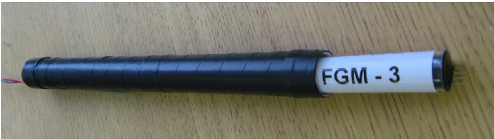
**Рис.2.** Магнитоэлектрический датчик с эталонной катушкой интерфейс которого представлен на **Рис. 3.**
