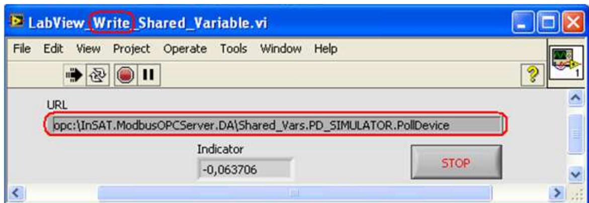
**Рис. 15.** Пример совместной работы двух процессов LabView клиента и InSAT Modbus OPC сервера. Один процесс считывает OPC данные, другой – вычисляет и передает данные OPC серверу. Сервер отображает значения переменных и состояние канала обмена данными.
