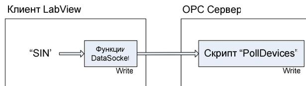
Используя показанные скрипт OPC сервера и блок-диаграммы LabView соберите и проверьте работоспособность генератора синусоидального сигнала в LabView. Переменная OPC сервера `opc:\InSAT.ModbusOPCServer.DA\Shared_Vars.PD_SIMULATOR.PollDevice` должна отслеживать состояние сигнала LabView.
