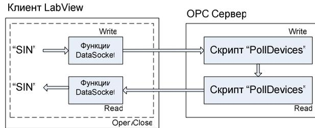
Используя показанные ниже состояние и скрипты OPC сервера и блок-диаграммы LabView соберите канал записи синусоидального сигнала LabView в ОС сервер и считывание записанных данных обратно в LabView. Переменная **opc:\InSAT.ModbusOPCServer.DA\Shared\_Vars.PD\_SIMULATOR.PollDevice** должна отслеживать значение передаваемых данных.
