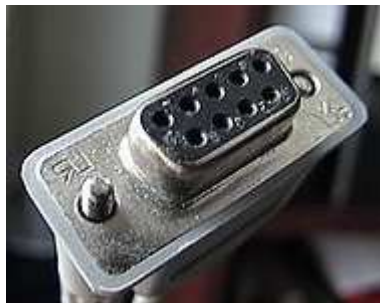
Рис. 1. Разъем DE-9, часто используемый для передачи по протоколу RS-232
