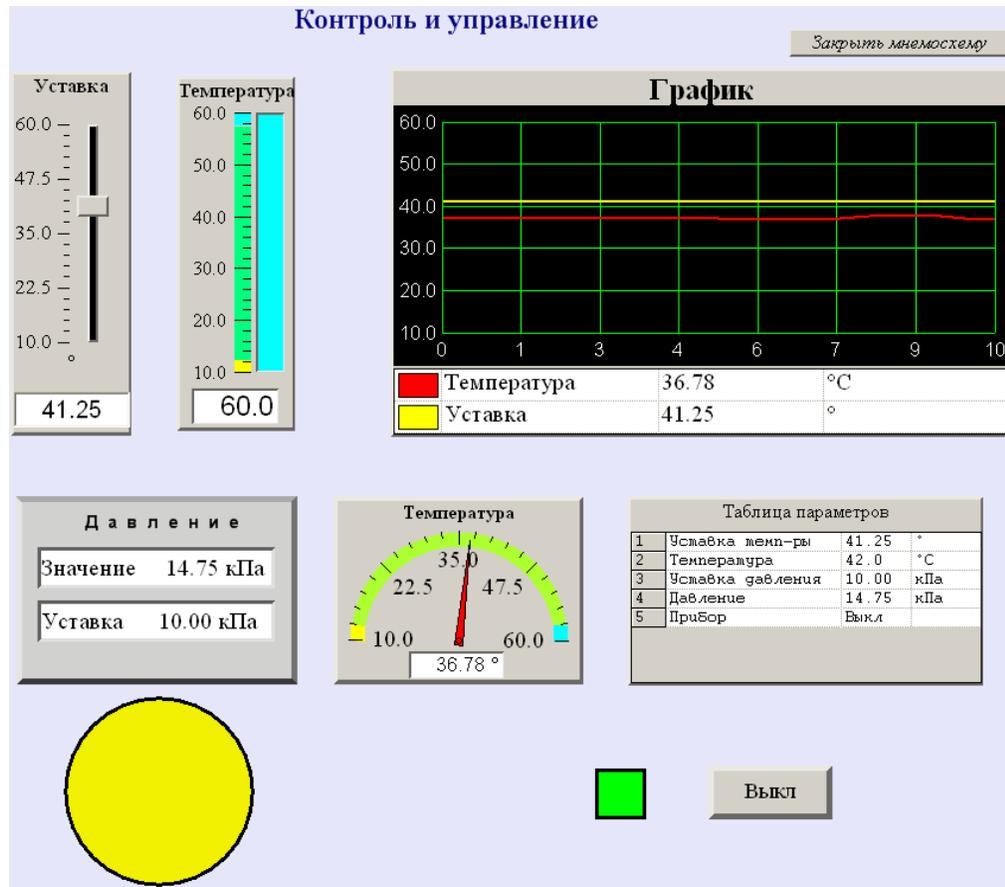
**Рис. 16.** Мнемосхема системы термостатирования.
