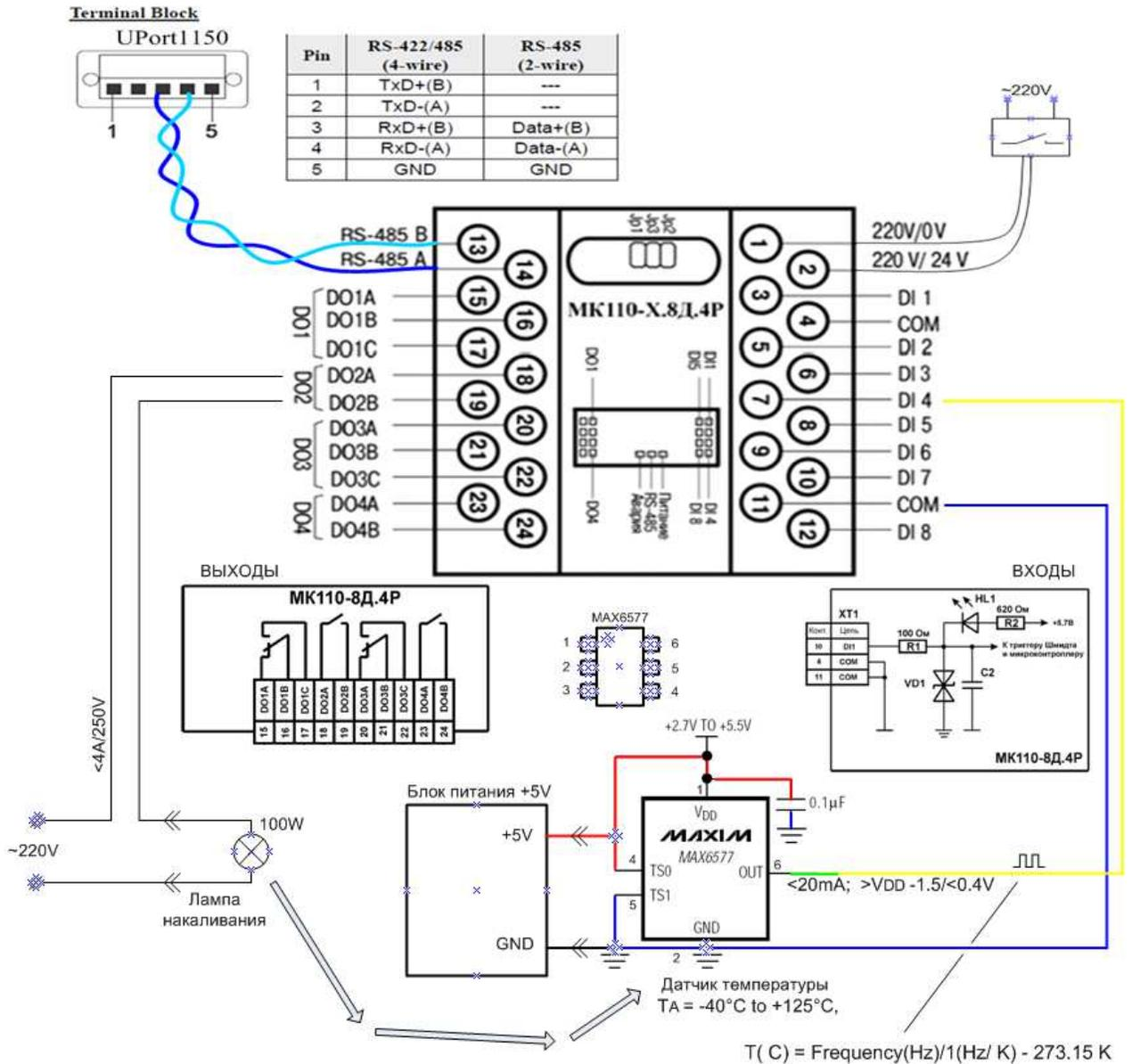
**Рис. 7.** Схема подключения внешних (физических) компонентов системы термостатирования.
