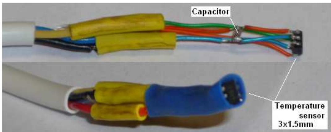
**Рис. 4.** Датчик температуры
