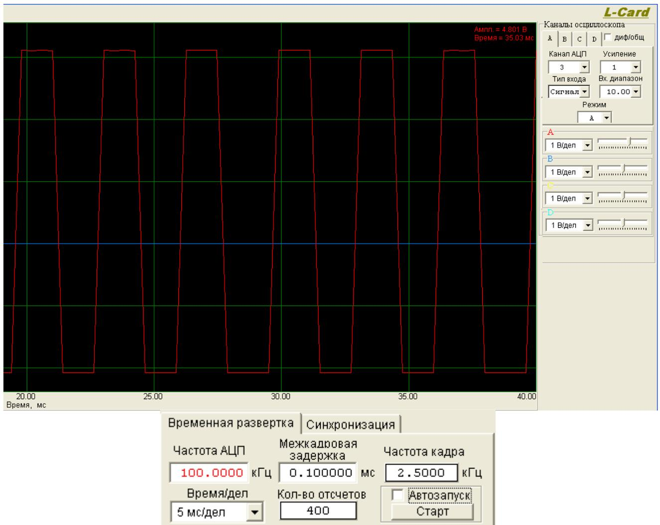
Рис. 3. Выходной сигнал датчика температуры - 4.8В при напряжении питания +5.2В.
