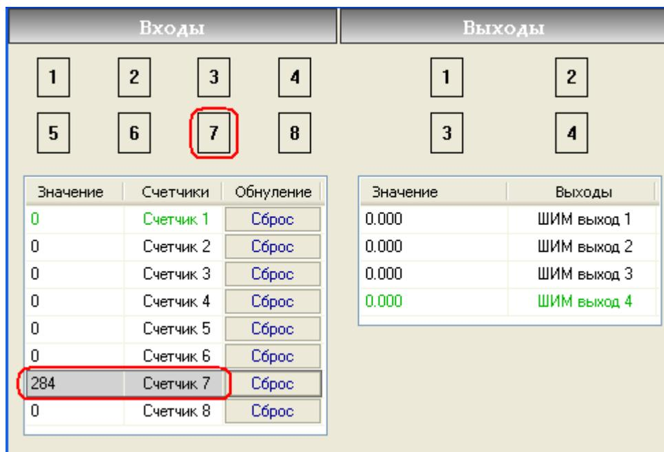
**Рис. 2.** Наблюдение за состоянием входов/выходов модуля ОВЕН МК110 при помощи программы «Конфигуратор M110».
