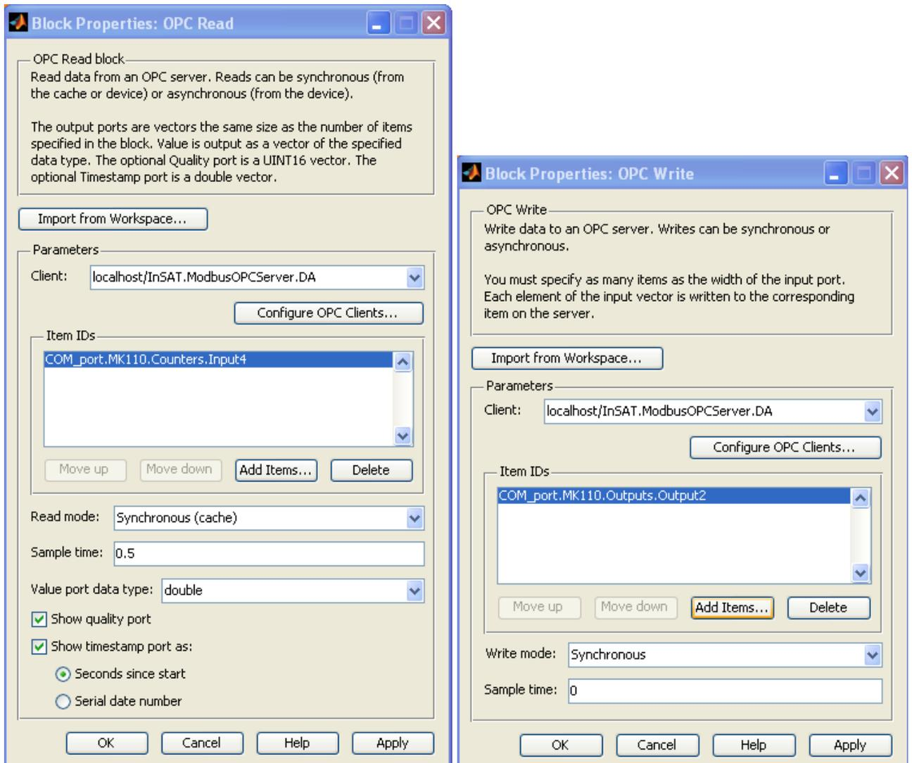
Рис. 13. Параметры блоков simulink модели.
