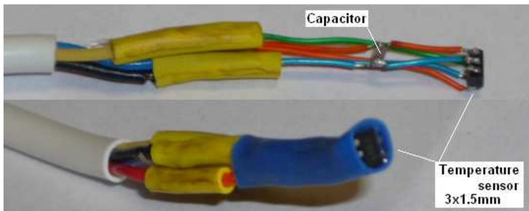
**Рис. 4.** Датчик температуры
