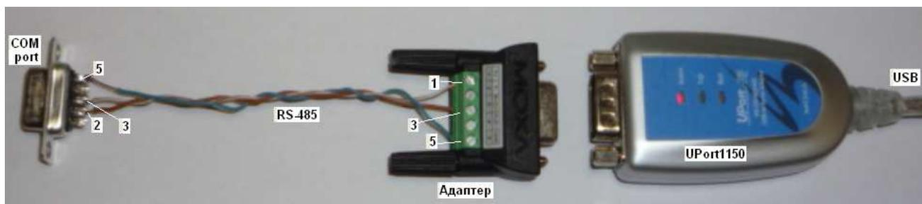
**Рис. 6.** Интерфейс RS-485 modbus канала преобразователя UPORT 1150
