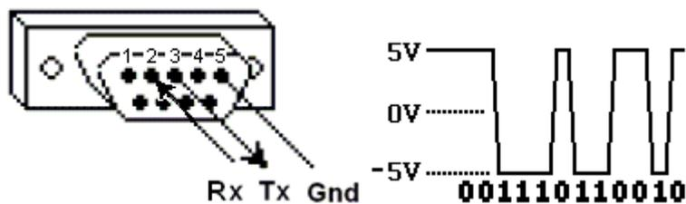
**Рис. 5.** Простейшее подключение modbus канала к последовательному порту
