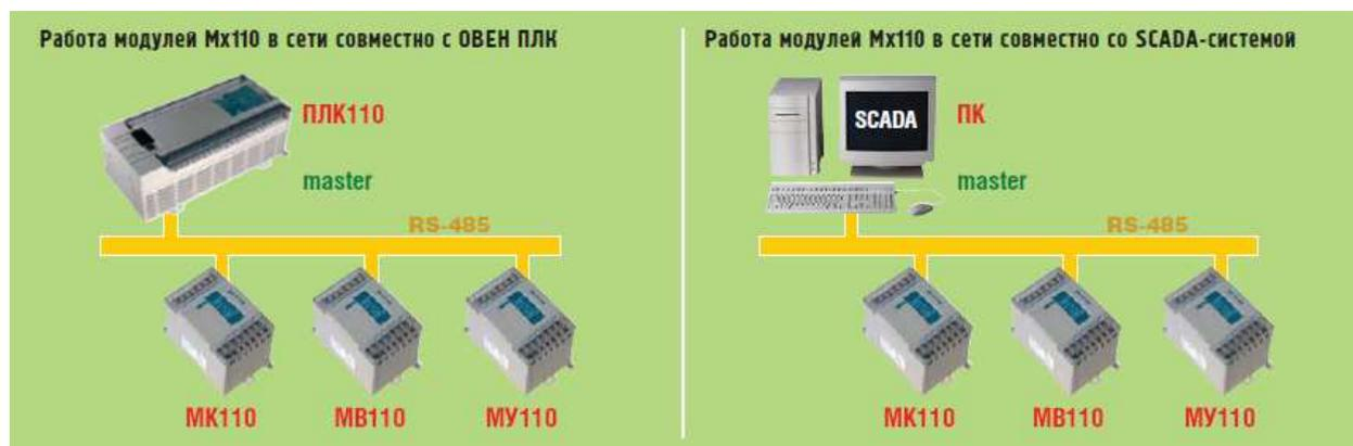
Модуль может быть использован в составе автоматизированных систем управления технологическими процессами в различных отраслях промышленности, может применяться для сопряжения различных датчиков и бесконтактных выключателей (основанных на емкостном, индуктивном, оптическом, ультразвуковом и др. принципах действия) с исполнительными механизмами.
